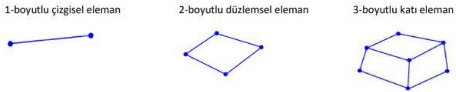
Şekil 3.1. Sonlu elemanlar element türleri (Çayıroğlu, 2021)
