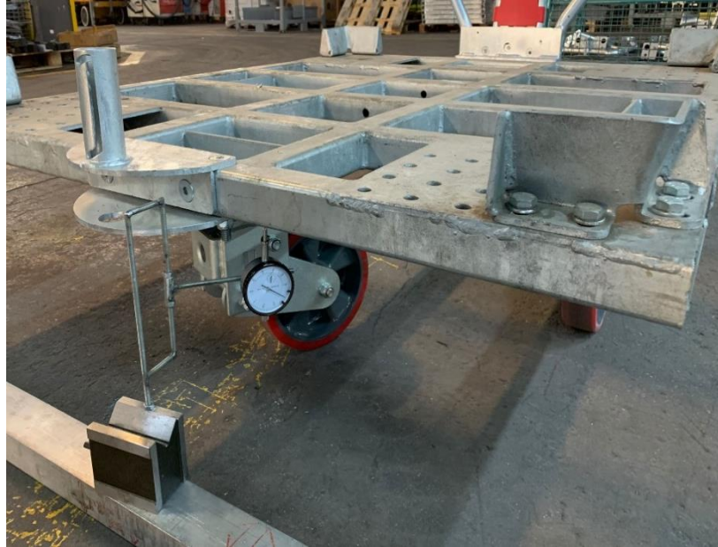
Şekil 4.9. Ölçüm öncesi özel taşıma römorku ve komparatör düzeneği
