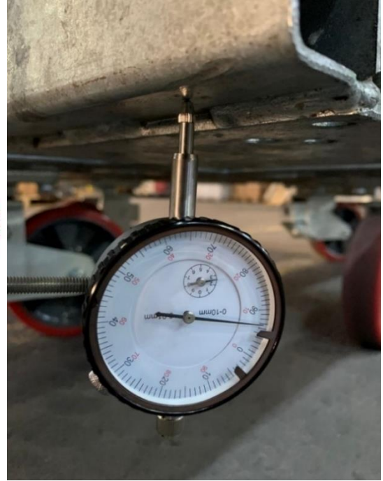
Şekil 4.12. Deformasyonun en fazla olduğu bölgedeki ölçüm değeri
