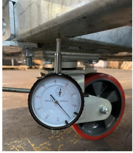
Şekil 4.11. Deformasyonun en az olduğu bölgedeki ölçüm değeri
