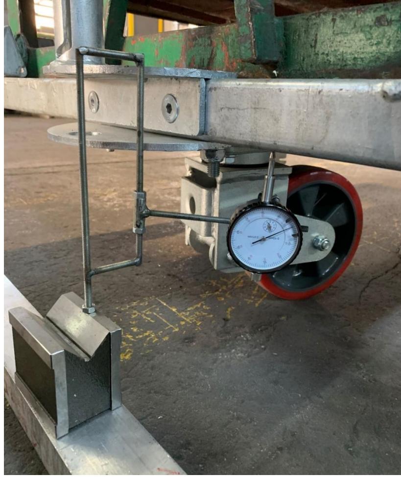
Şekil 4.10. Özel taşıma römorkları için hazırlanan komparatör ölçüm düzeneğinin yakın görseli
