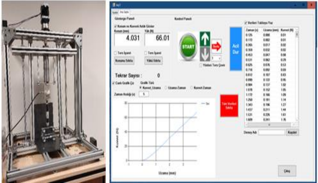
Şekil 3.2. Masaüstü mekanik test cihazı ve kullanıcı arayüzü
