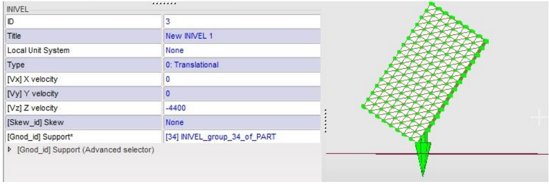
Şekil 3.10. Numunelere uygulanan çarpışma testi
