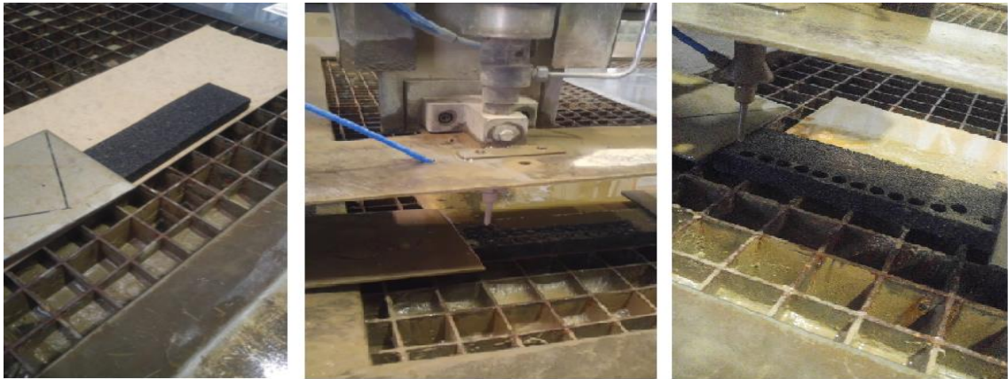
Şekil 3.1. EPP köpük levhanın su jetine yerleştirilmesi, kesimi ve levha üzerinden numune alımı
