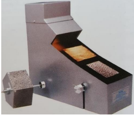
Şekil 3.11. Pilliscope cihazı (SDL Atlas cihaz kataloğu, 2016)
