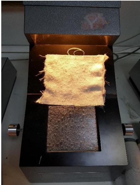
Şekil 3.12. Pilliscope cihazında numune değerlendirme
