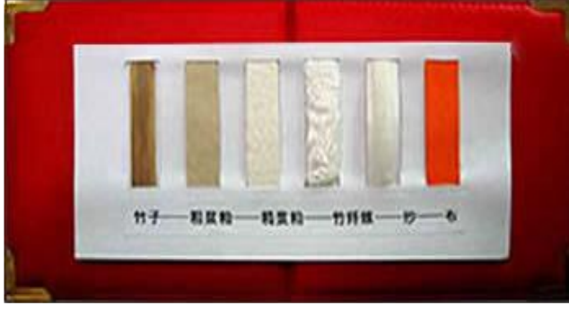
Sekil 2.11. Bambunun, bambu kamışından kumaş oluşumuna kadar değişim aşamaları (Bambrotex, 2020).
