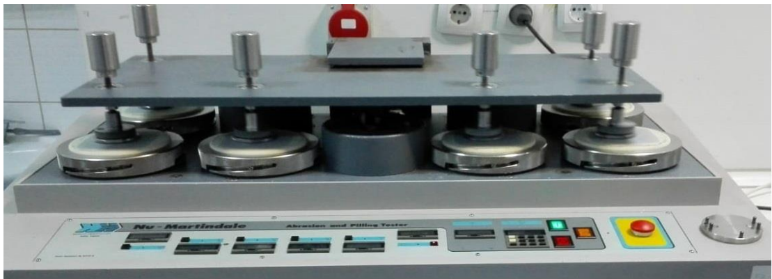
Şekil 3.3. Aşınma ve boncuklanma test cihazı
