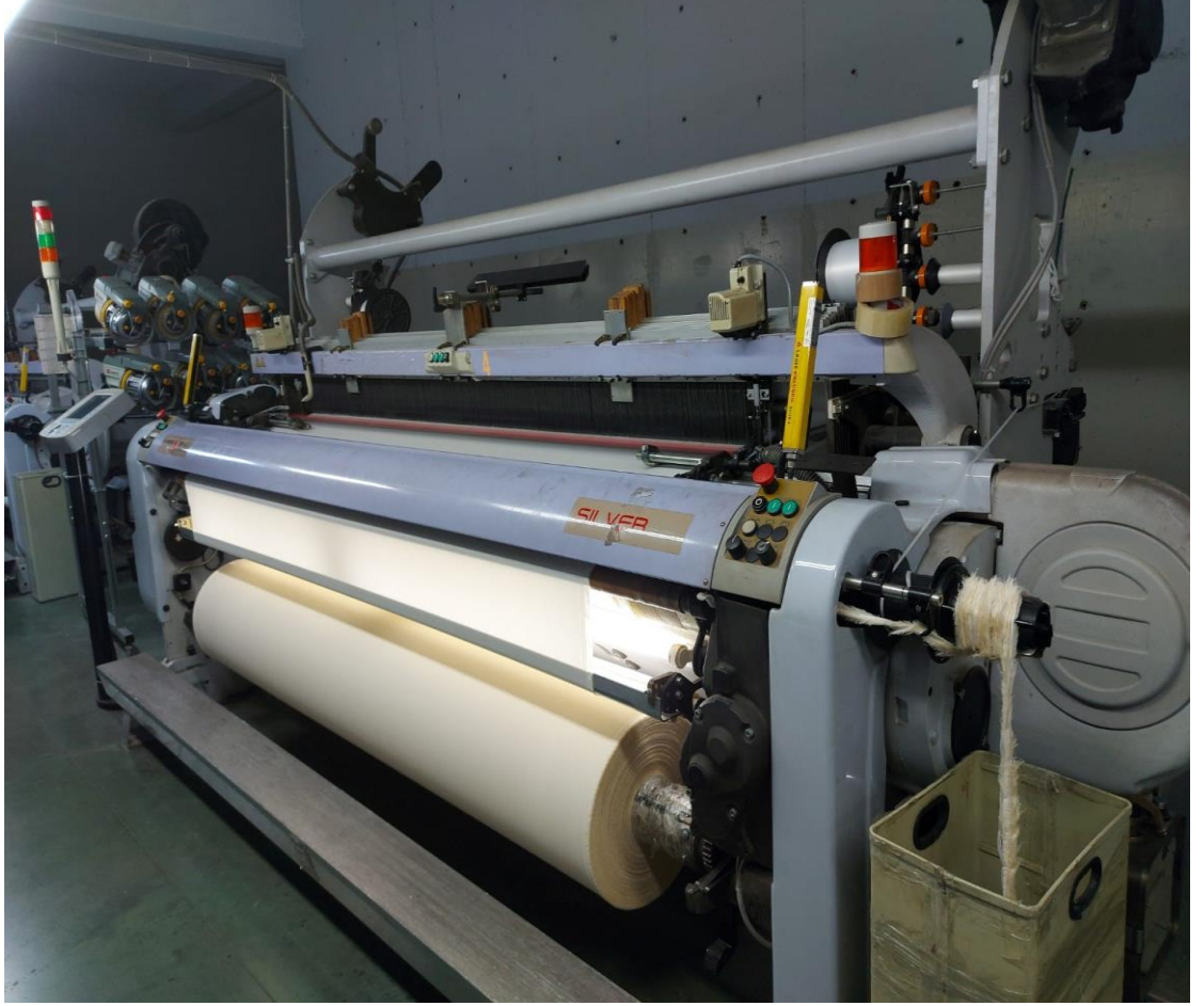
Şekil 3.2. Numune kumaşların üretildiği Vamatex armürlü dokuma makinesi
