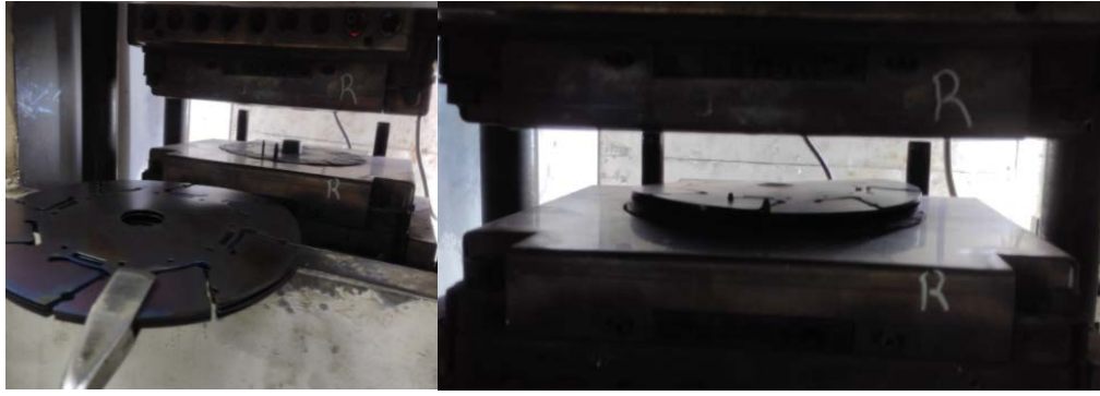
Şekil 4.4. Sıcak Form Kalıbına Yüklenen Parçalar
