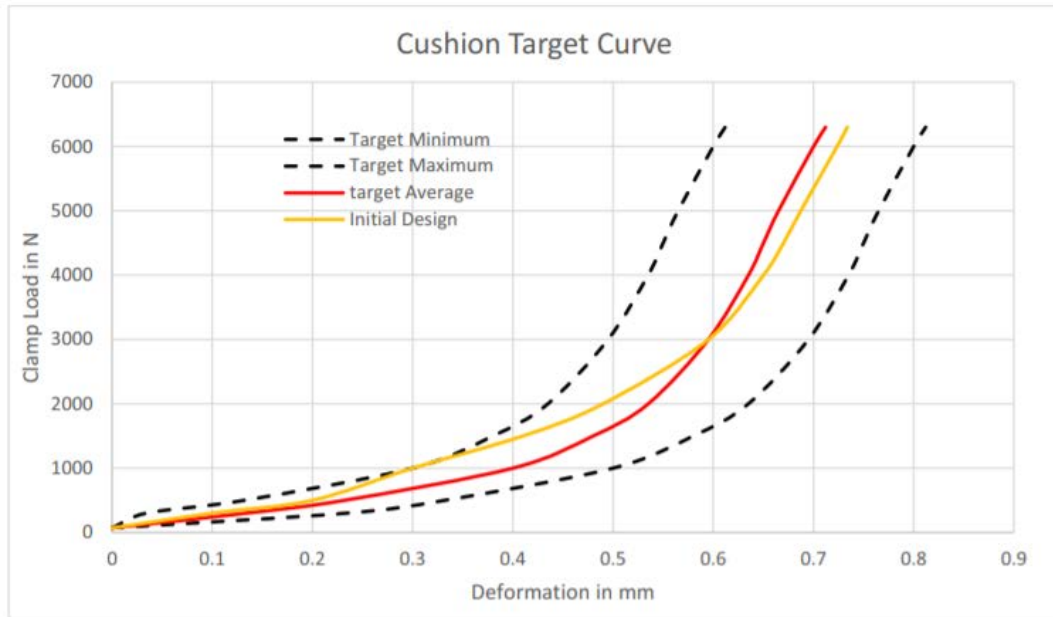
Şekil 2.4. İlk Tasarım Yastıklama Yayı Rijitlik Eğrisi (Vivek Thacker 2018)
