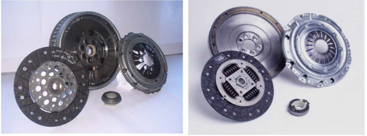
Şekil 1.6. ÇKV'li Debriyaj Kiti (Solda) ve Tek Kütleli Konvansiyonel Kit (Sağda)
