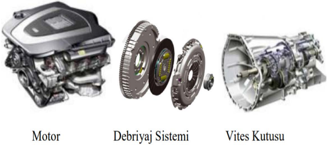
Şekil 1.1. Debriyaj Sistemi Elemanları
