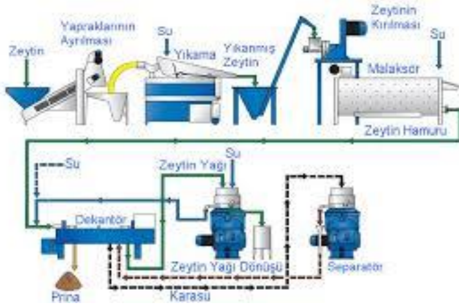
Şekil 3.3. Sürekli Sistem Zeytinyağı Üretimi
