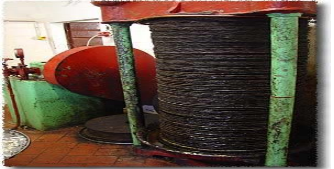
Şekil3.1. Geleneksel Baskı Yöntemi
