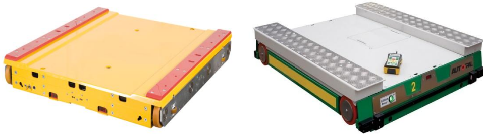
Şekil 1.2. Farklı tipteki mekik araçları
