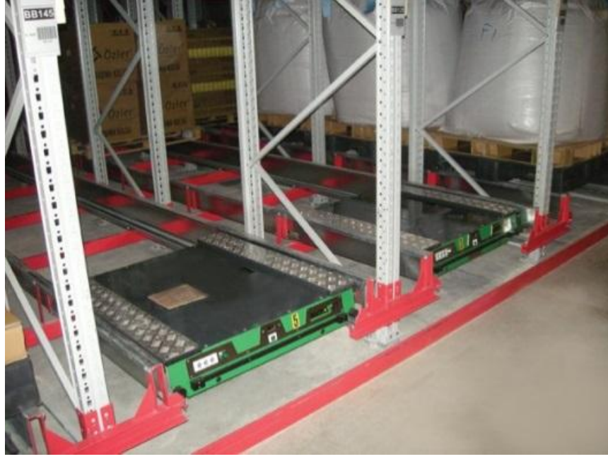
Şekil 1.1. Mekik depo görünümü ve mekik aracı
