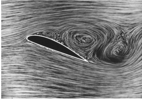
Şekil 2.11. Bir uçak kanadı üzerindeki ayrılmış akışın gösterimi (Görsel https://nptel.ac.in/content/storage2/courses/101106041/Chapter%203%20Lecture%208%202020-12-2011.pdf adresinden alınmıştır.)
