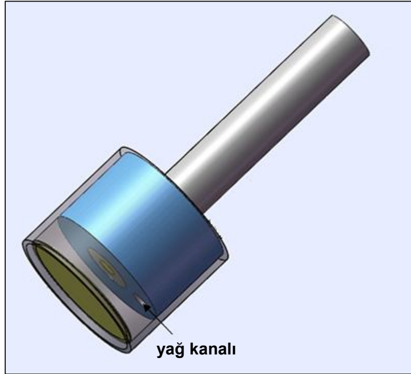
Şekil 5.47. Kanal Açılmış Optik Fiberli Akustik Sensör Ön Görünüşü
