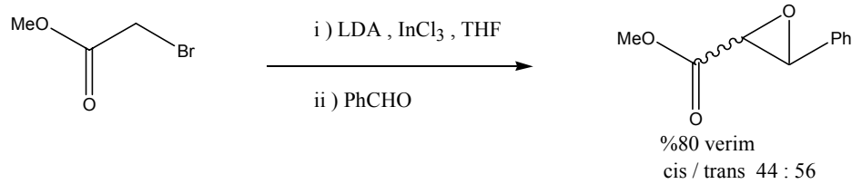
Şekil 2.1.1.15. Metil bromasetatın Darzen koşullarında glisidat türevlerine dönüştürülmesi
