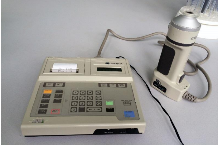
Şekil 3.6. Renk okumalarının gerçekleştirildiği Minolta CR-300 kolorimetre
