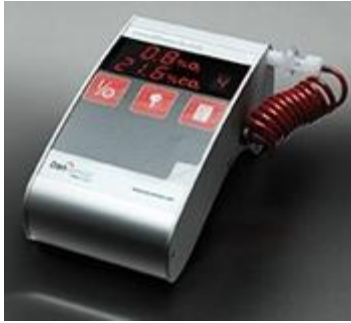
Şekil 3.11. Ambalaj içindeki O 2 ve CO 2 miktarını ölçen Dansensor Checkpoint
