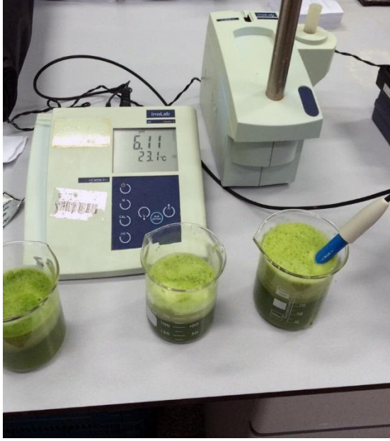
Şekil 3.8. pH ölçümlerinin gerçekleştirildiği Inolab pH metre
