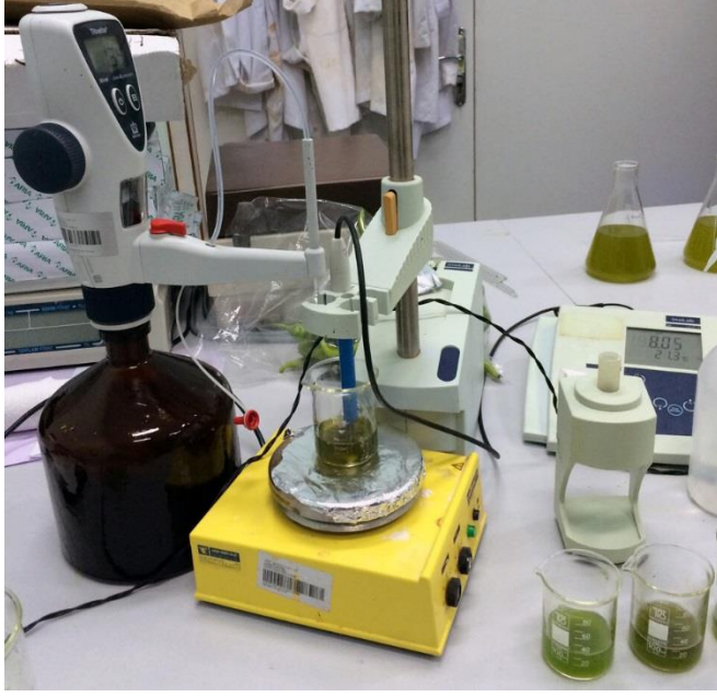
Şekil 3.9. 0,1 N NaOH ve pH metre yardımı ile gerçekleştirilen titrasyon işlemi
