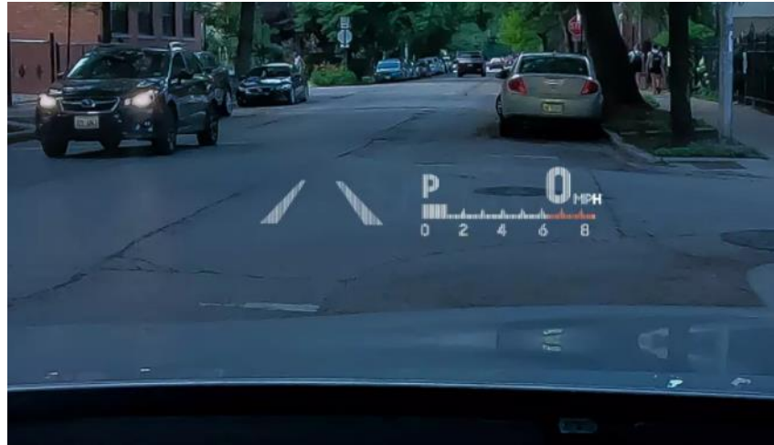
Şekil 2.4. HUD Sisteminin Otomotive Entegrasyonu (Anonim, 2021)
