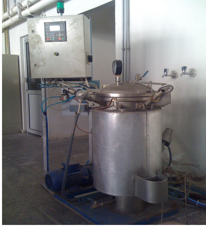
Şekil 3.2. Tasarlanan laboratuvar tipi vakumlu buharlama kazanı
