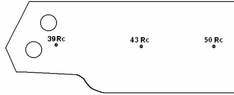
Şekil 2. Freze bıçağı üzerindeki ortalama sertlik dağılımı
