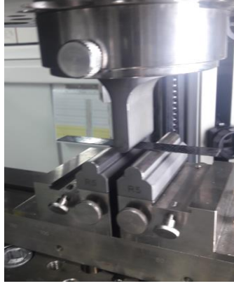
Şekil 23. 3 Nokta eğme testi
