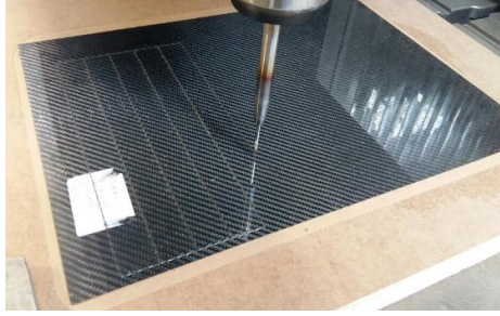
Şekil 18. Test plakalarının kesilmesi
