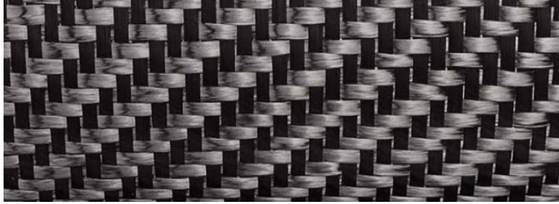
Şekil 2. 3K 2x2 Twill örgü karbon elyaf kumaş
