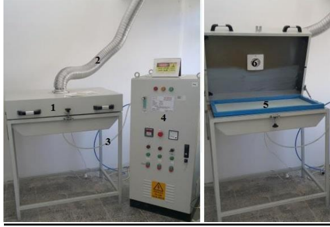
Şekil 2.3. Ozon aşındırma ekipmanı şeması (1.Ozonlama Kabini, 2.Tahliye Borusu, 3.Ozon İletim Borusu, 4. Ozon Jeneratörü, 5. Şablon, 6. Tahliye Fanı)
