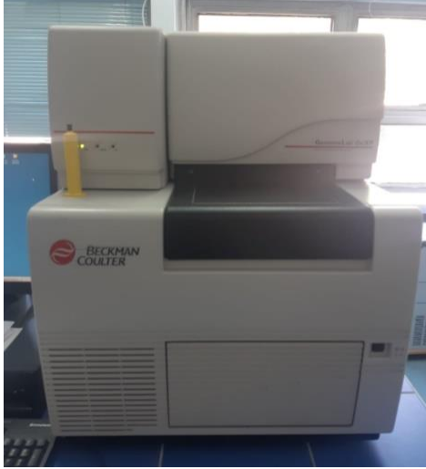
RESİM 2.3.2: DNA dizi analizi yapılan Beckman Coulter Analiz Sistemi.
