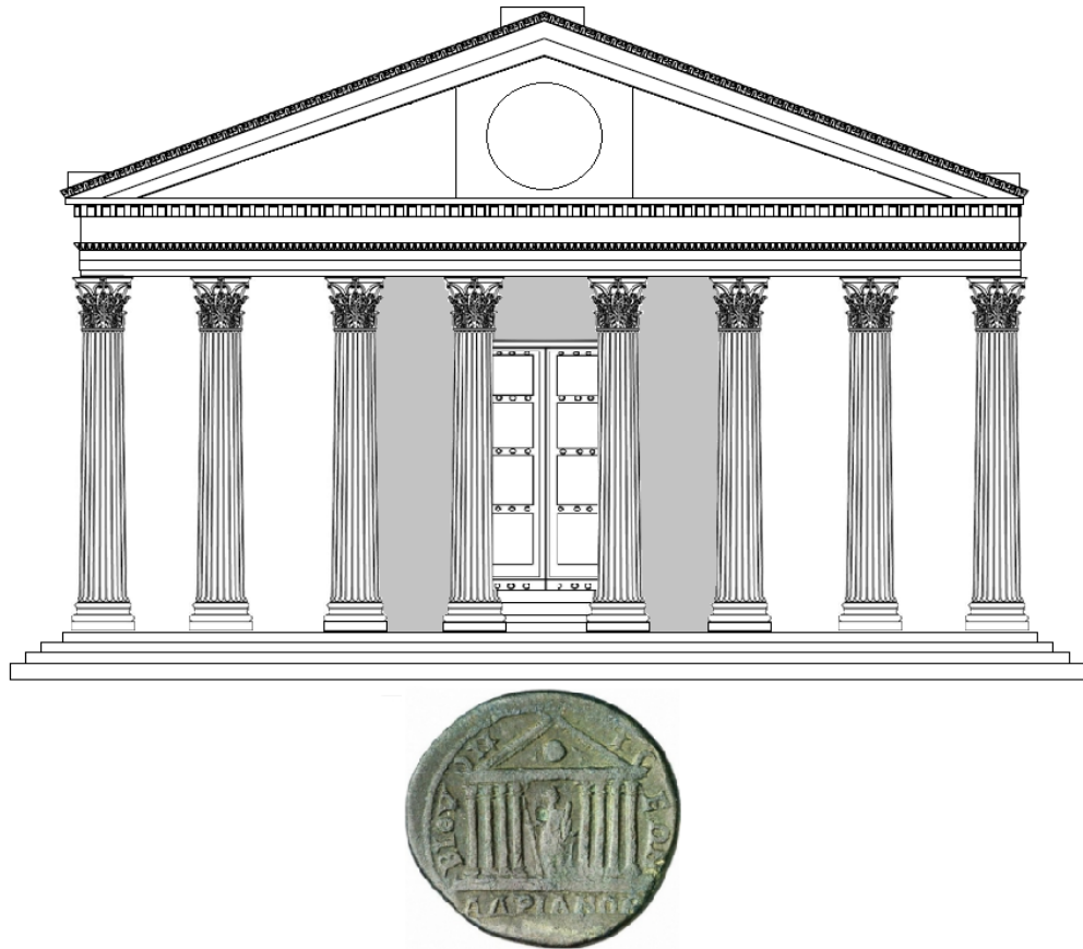
Çizim 14: Sikke Betimlerine Göre Bithynion'daki İmparator Tapınağı'nın Ön cephe Rekonstruksiyon Önerisi
