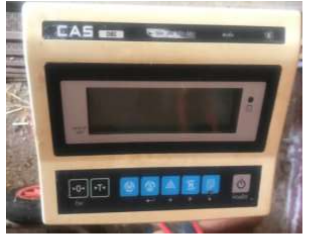
Şekil 3.7. Buzağı canlı ağırlık tartımında kullanılan taşınabilir kantar
