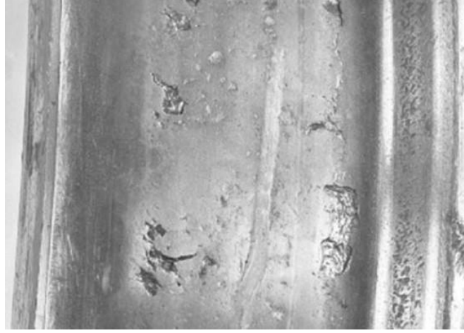
Şekil 2.59. Teker yüzeyi yorulma kusuru örneği (Lewis & Olofsson, 2009)
