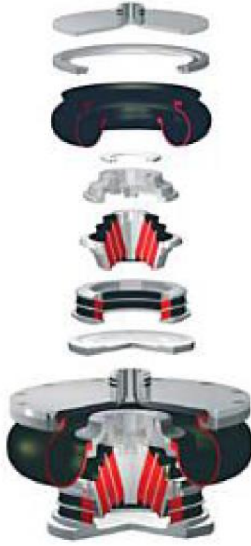
Şekil 2.12. Havalı süspansiyon bileşenleri (SKF, 2012)
