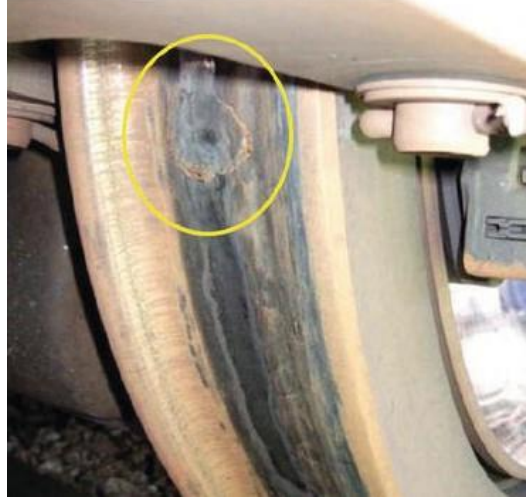
Şekil 2.28. Raylı taşıt tekerinde apleti örneği (Hessami, 2018)
