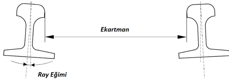
Şekil 2.24 Ray eğiminin şematik gösterimi (Popovici, 2010)
