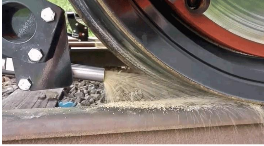
Şekil 2.29. Raylı taşıtlarda kumlama sistemi (Anonim, Network Rail to carry out pioneering autumn train braking trials, 2019)
