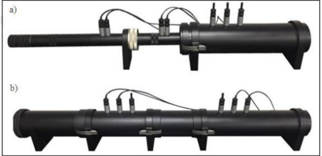
Şekil 3.15. a) 29 mm ve b) 100 mm çaplarındaki empedans tüpleri (Tunahan Doğru, 2020).
