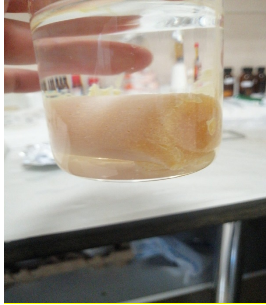
Şekil 3.7. Metanol içerisinde yaşlandırma sırasında poliüretan-poliimid hibrit jel
