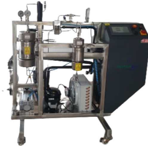
Şekil 3.2. Superex Aero-1000 (süperkritik CO 2 kurutma cihazı)
