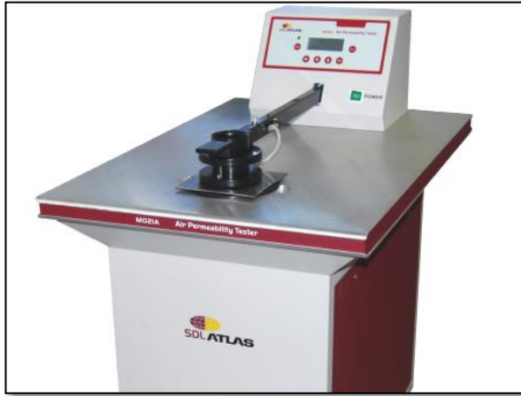
Őekil 3.6. Hava geirgenlik test cihazı (Anonim, 2020)
