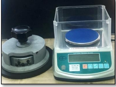
Şekil 3.4. Kumaş birim alan kütle ölçüm aleti
