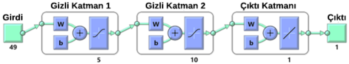
Şekil 4.23. Fon portföy dağılımı ile DBP'nin kapanış fiyatının tahmini için geliştirilen iki gizli katmanlı YSA model mimarisi (eğitim algoritması: BR, model: 49-5-10-1)
