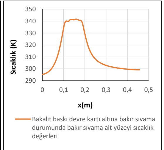
Ek Şekil 4.20. Bakalit baskı devre kartı alt yüzey sıcaklığı
