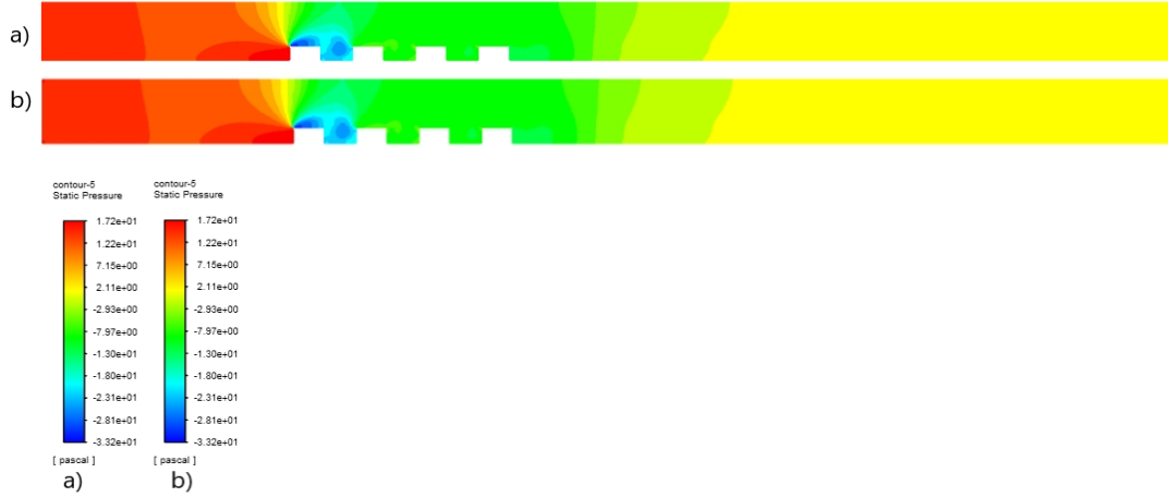
Şekil 4.295. Re=9015 (5,42 m/s) için basınç kontürleri a) Bakalit baskı devre kartı altına bakır sıvama yapılmış b) FR-4 baskı devre kartı altına bakır sıvama yapılmış
