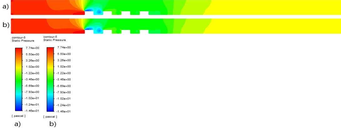
Şekil 4.286. Re=6000 (3,607 m/s) için basınç kontürleri a) Bakalit baskı devre kartı altına bakır sıvama yapılmış b) FR-4 baskı devre kartı altına bakır sıvama yapılmış
