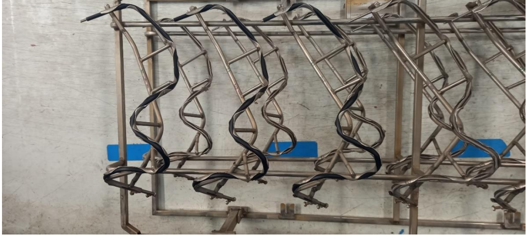
Şekil 3.18. Fırın prosesine girmek üzere kalıp gözlerine yerleştirilen yakıt boruları
