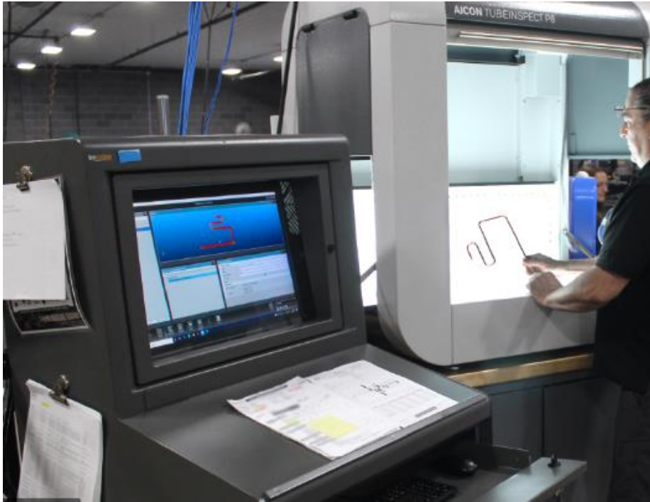
Şekil 3.11. Tersine mühendislik ile taramanın yapıldığı AICON makinesi-1 (Anonim4, 2022)
