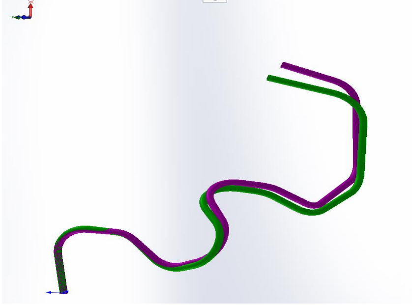
Şekil 4.3. Analiz sonucuna göre elde edilen datanın fırın prosesi sonrası taranan data ile çakıştırılması-2
