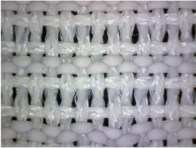
Şekil 3.12. B4 kumaşı mikroskop görüntüsü (50 kat büyütme)
