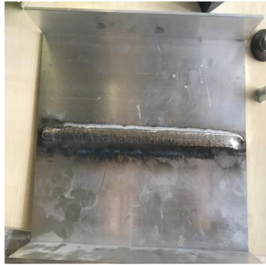
Şekil 3.3. Ark alın kaynağı atılan 3mm levhalar
