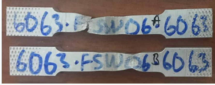
Şekil 4.24. Çekme testi sonrası kopan 8mm SKK 6 numunelerinin görselleri
