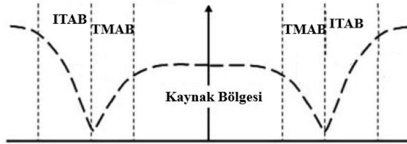
Şekil 1.19. SKK kaynağı sertlik değişim grafiği (Gallais ve ark., 2007, değiştirilerek alınmıştır.)
