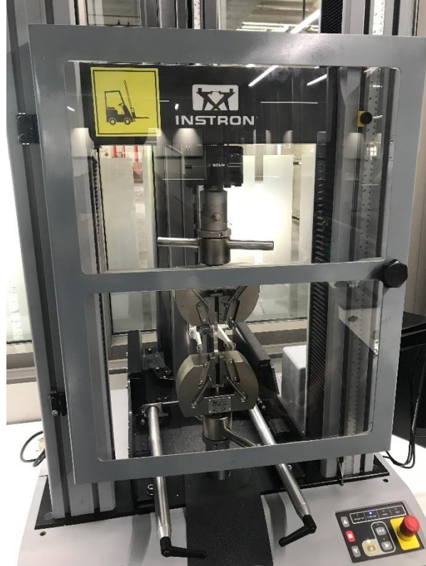
Şekil 3.16. Çekme testi cihazı ve işlem anındaki görseli
