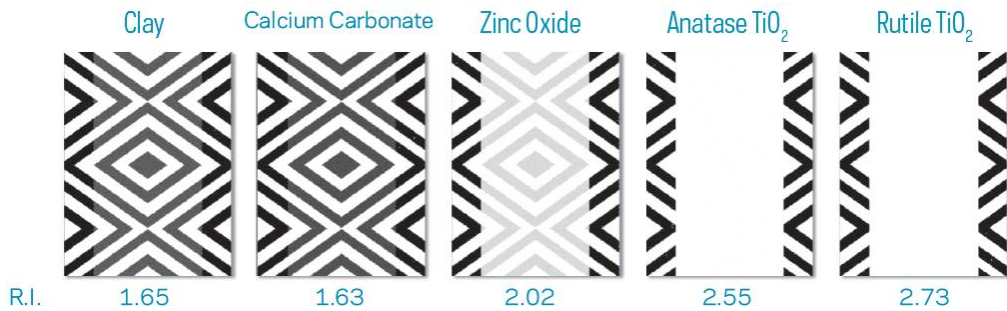
Şekil 4.7. Kırılma indisinin opaklık üzerindeki etkisi (“Titanium Dioxide for Coatings”, 2019).
