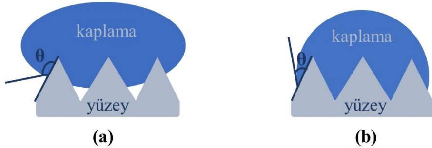
Şekil 2.2. Pürüzlü yüzey üzerinde zayıf ıslatabilirlik (a) ve iyi ıslatabilirlik (b) özelliğine sahip sıvıların davranışı (Shim, 2019'dan düzenlenmiştir).
