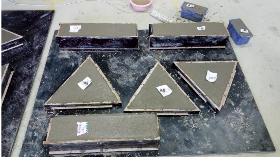
Şekil 3.16. 24 saat plywood kalıplarda bekletilen kiriş ve 50 cm üçgen numuneler
