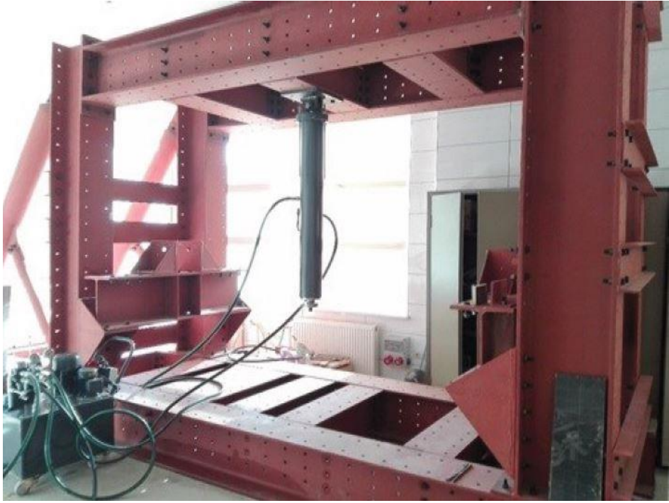
Şekil 3.8. Üçgen plaka deneylerinde kullanılan yükleme çerçevesi ve hidrolik piston
