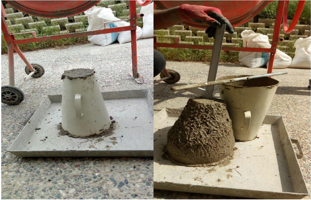
Şekil 3.20. Lifli bir karışıma ait çökme deneyi görseli
