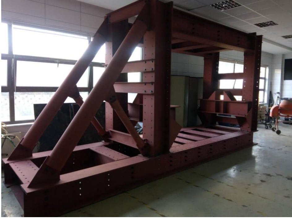
Şekil 3.7. Üçgen plaka deneylerinde kullanılan yükleme çerçevesi
