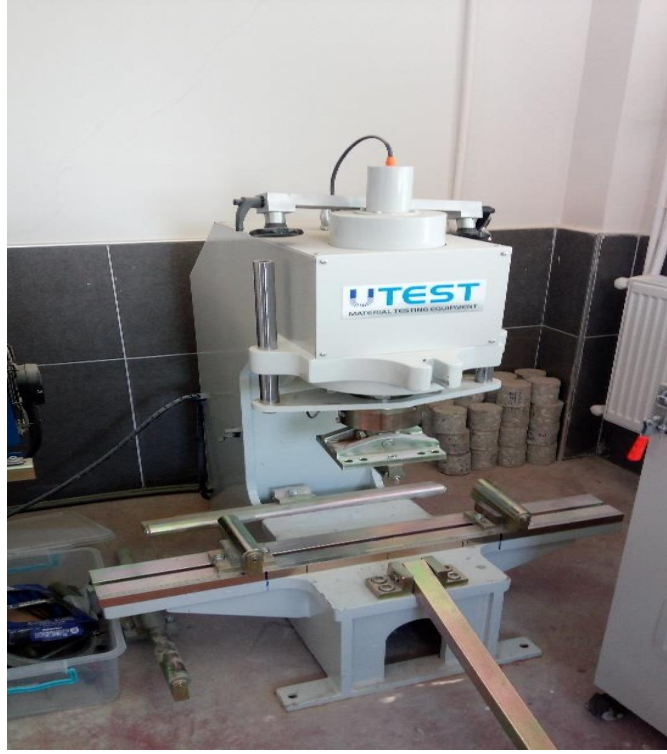
Şekil 3.12. Eğilmede çekme dayanımının belirlenmesi için deney aleti
