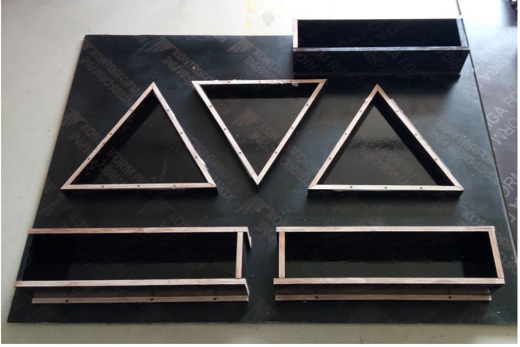
Şekil 3.4. 500×500×50mm üçgen plaka ve 150×150×650mm kiriş kalıpları
