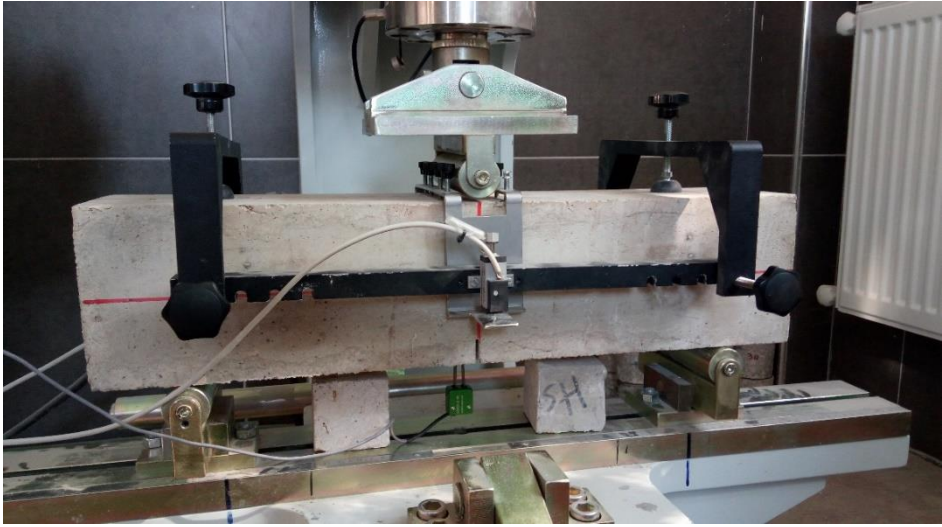
Şekil 3.19. EN 14651:2005+A1:2007 standardına göre deney düzeneği
