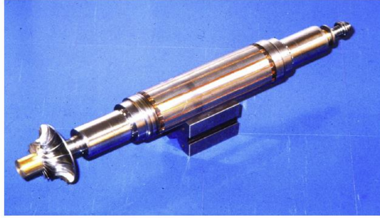
Şekil 2.10. Jeneratör ve besleme pompalı radyal türbin girişi (Bronicki, 2017)
