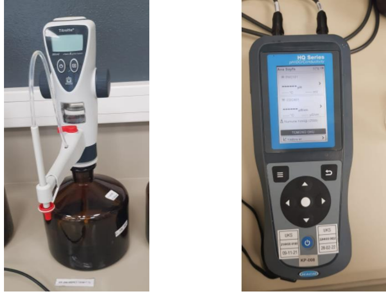
Şekil 3.13. Kimyasal oran tayini ekipmanları
