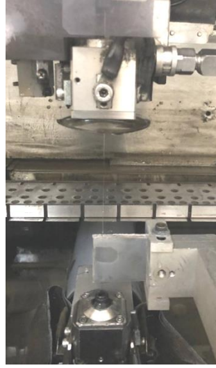
Şekil 3.39. Tel erezyon yöntemiyle basma testi numunelerinin profillerden çıkartılması
