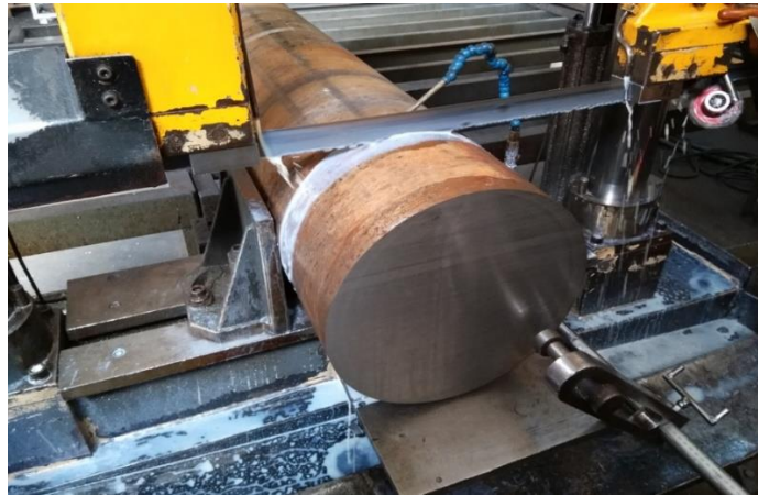
Şekil 3.28. Şerit testere ile kesim
