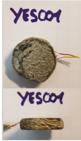
Şekil 3.9. Test sonucu deforme olmuş numune örneği
