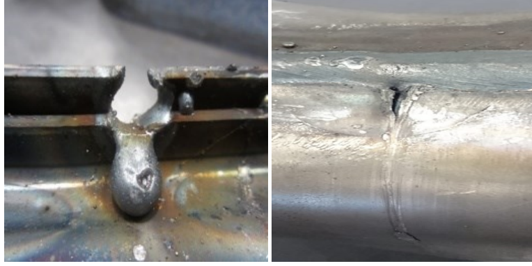
Şekil 4.6. Eğitim ve test verisi için bölünen hatalı gazaltı parça örnekleri
