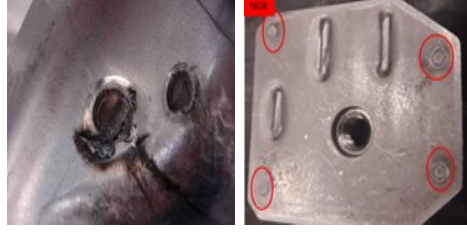
Şekil 4.4. Eğitim ve test verisi için bölünen hatalı punta parça örnekleri
