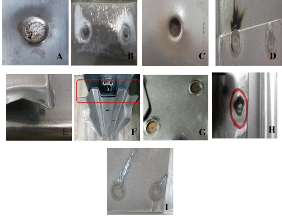
Şekil 3.11. Punta kaynak hataları A) Delik punta B) Küçük çekirdek C) Çökertmeli punta D) Kenar punta E) Kopuk punta F) Çift sac punta G) Deformeli punta H) Üst üste punta I) Punta çapak
