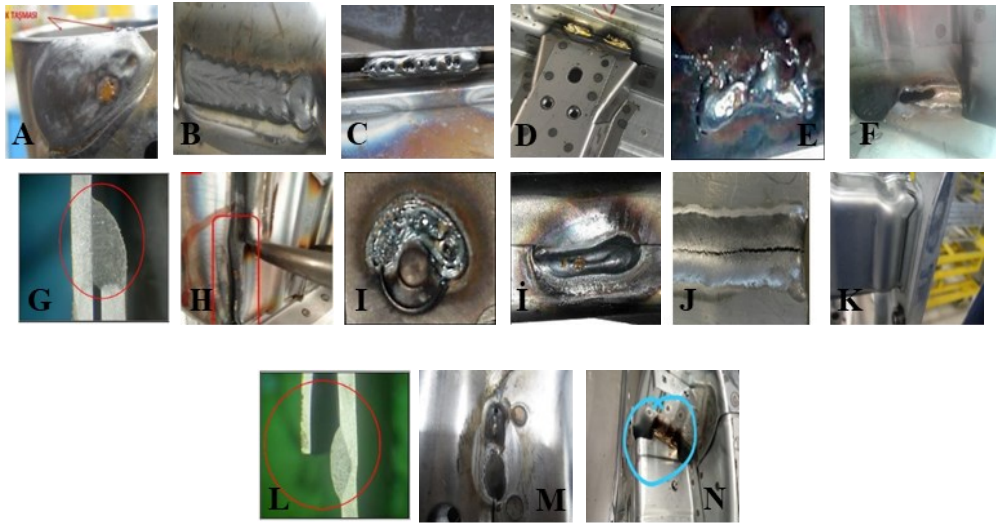
Şekil 3.12. Gazaltı kaynak hataları A) Aşırı penetrasyon B) Çentik kaynak C) Gözenek D) Saclar arası boşluk E) Çapaklı F) Delik G) Eksik kaynak H) Penetrasyon eksik I) Kaynak dikişinde incelme İ) Kaynakta köpürme J) Çatlak K) Hatalı Rota L) Kopma M) Kesintili kaynak N) Yetersiz kaynak dolgusu
