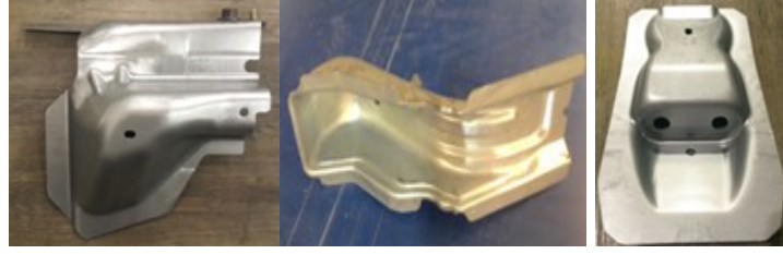
Şekil 4.9. Çatlak olmayan parçalar
