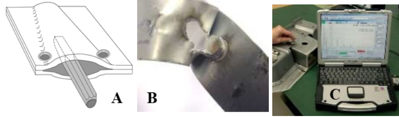
Şekil 3.10. Punta uygunluk doğrulama kontrolleri A) Yarı tahribatlı B) Tam tahribatlı C) Ultrasonik kontrol
