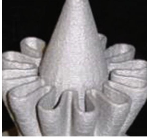
Şekil 2.22. Gaz türbini egzozunun altıda bir ölçekli karıştırma nozülü (Liu ve ark. 2017)
