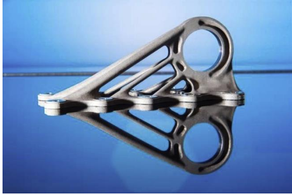
Şekil 2.25. Airbus A350 XWB'de eklemeli üretim kullanılarak üretilen ilk titanyum braket konektörü (Liu ve ark. 2017)
