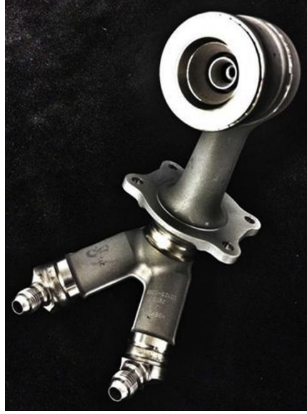
Şekil 2.24. EOS cihazı ile üretilen GE yakıt nozülü (Liu ve ark. 2017)
