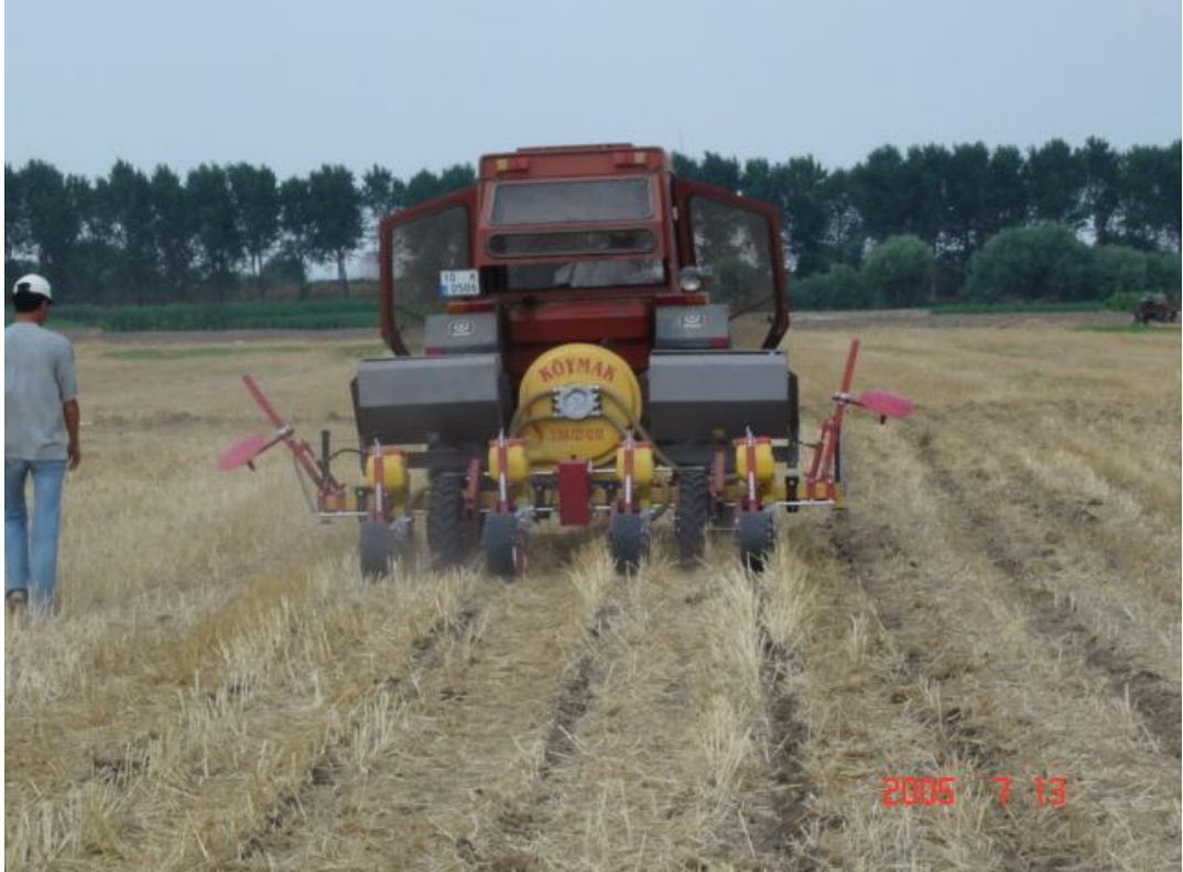
Şekil 2.1. Anıza ekim yapan özel ekim makinesi
