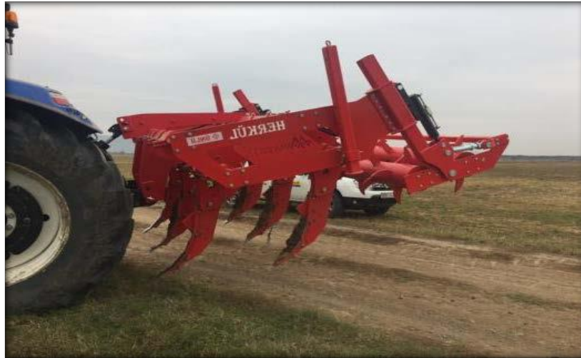
Fotoğraf 17: Toprak İşleme İçin Kullanılan Dip Kazandan Görünüm Kaynak: “Tarımsal Mekanizasyon” tigem.gov.tr, Erişim Tarihi: 18.05.2022
