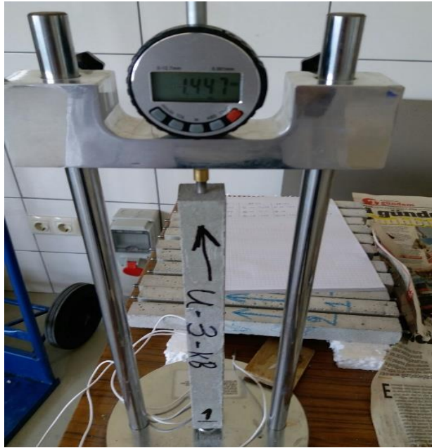
Şekil 4.2. Harç karışımlarının kuruma rötresi ölçümü
