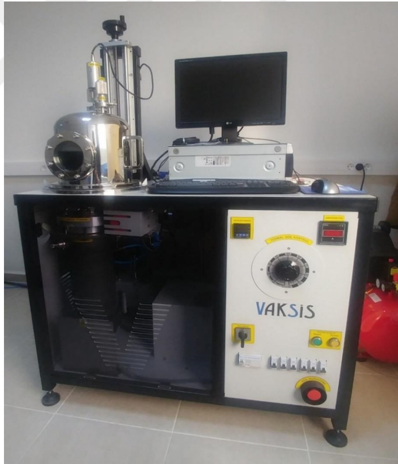
Şekil 3.4. Ön ve arka kontak oluşturulurken kullanılan Vaksis PVD Handy 2 termal buharlaştırma sisteminin görüntüsü (Uludağ Üniversitesi Fen-Edebiyat Fakültesi Fizik Bölümü İnce Film Karakterizasyon Laboratuvarı).
