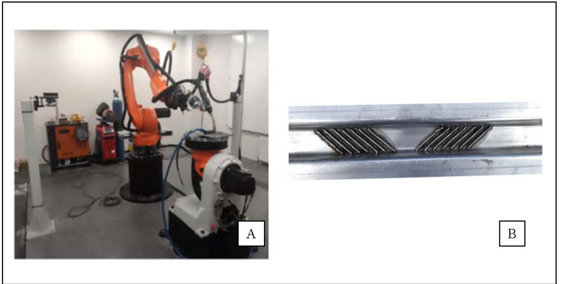
Şekil 3.27. Prototip üretimi. A) DED cihazı B) Hibrit DED atkı parçası
