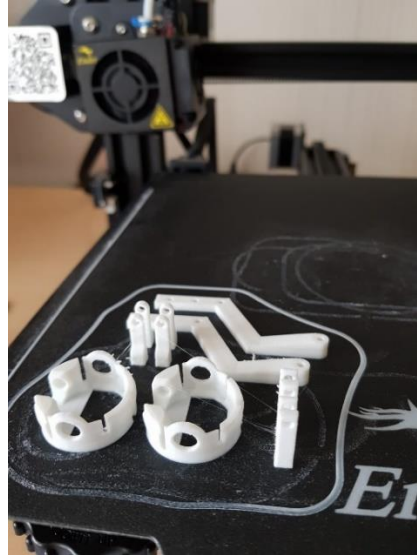
Şekil 19. Üç Boyutlu Yazıcıda Göz Kürelerinin Mekanizmasının Basımı
