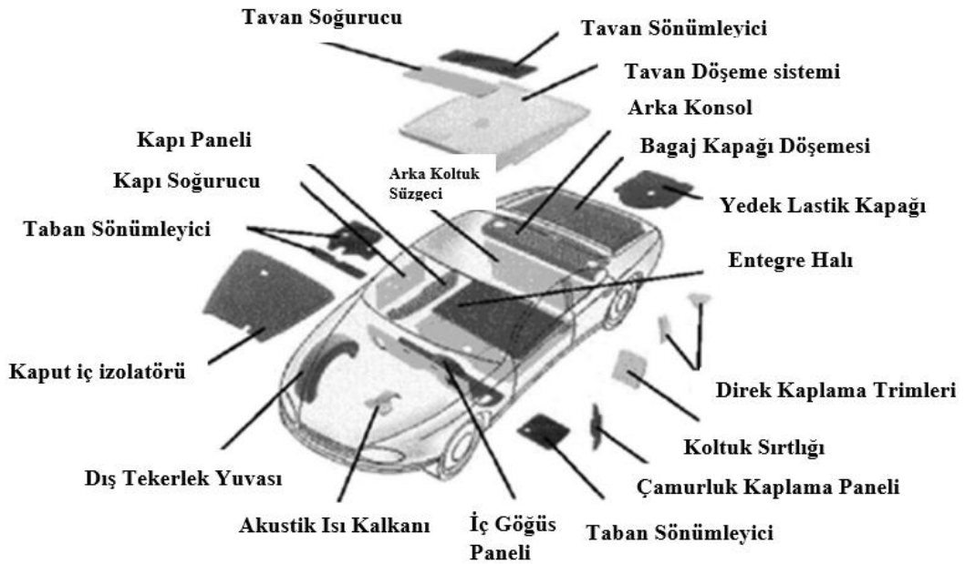
Şekil 2.6. Bir araçta uygulanan bazı ses yalıtım ve soğurma malzemeleri (Chen, 2012)
