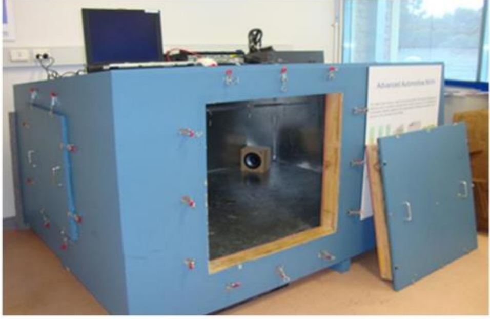
Şekil 3.9. Rastgele gelen ses yutma katsayısı için alfa kabin ölçüm düzeni (Mohamed & Egab, 2020)
