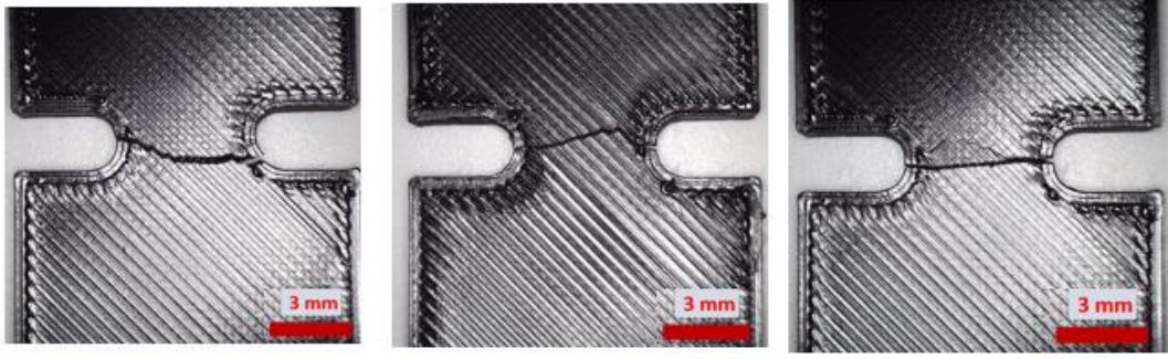
Şekil 4.33. \pm 45^\circ yazdırma desenine sahip U çentik numunenin kırılma ilerleyişi ve kırılma ilerleyişi
