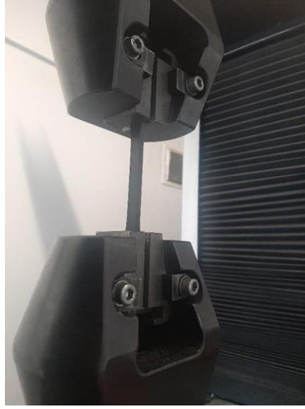
Şekil 3. 5. WDW-100C çekme testi cihazına yerleştirilen ASTM 638 deney numunesi
