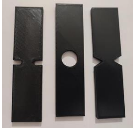
Şekil 3. 13. \pm 45^\circ doldurma açılı U, O, V çentik numune
