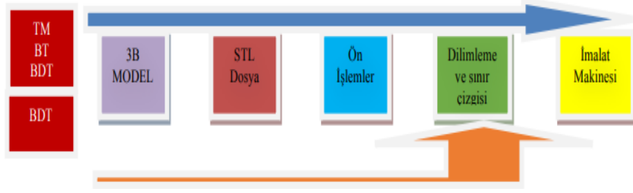
Şekil 2. 1. Eklemeli üretim işlemi akış şeması
