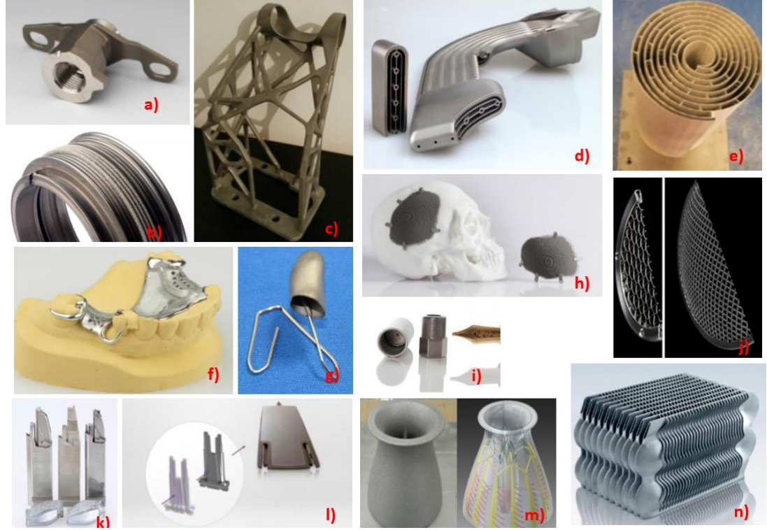
Şekil 16. a)A320neo Geared Turbofan™ motor için boroskop başlıkları; b)labirent contanın aşınmış dudaklarının onarımı; c)Uydu anteni için destek; d)RSC Emisyon Tarağı; e)Vakum permeatörü; f)Çıkarılabilir Kısmi Takma Diş (RPD) İskeleti; g)İşitme cihazı; h)Kraniyal implant; i)Basınç sensörü muhafazası; j)Temizlenebilir Filtre Diski; k)Kalıp döküm için takım; l)Takım parçaları; m)Kalıp/nozül, vb.'de uyumlu soğutma kanalı; n)Isı eşanjörü prototipi (Anonim, 2019d)
