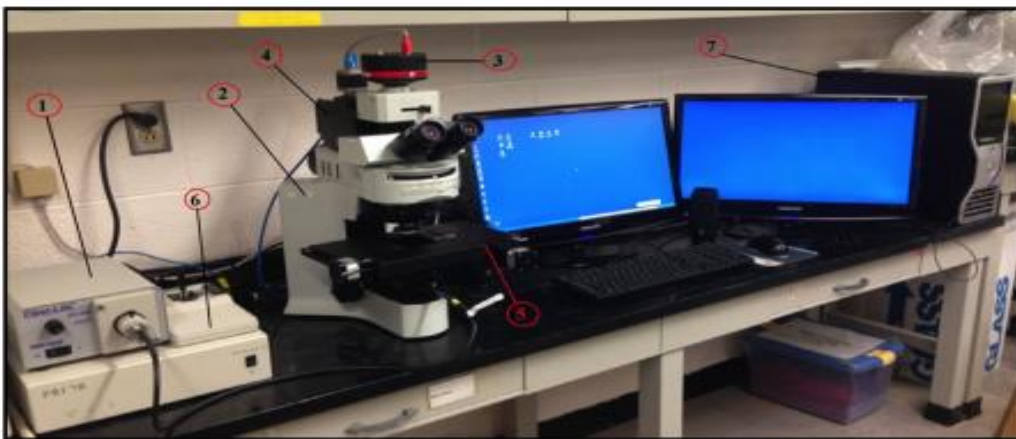
Şekil 20. Hiperspektral görüntüleme için mikroskop sistemi, 1: halojen ışık kaynağı; 2: optik mikroskop; 3: optik kamera; 4: VNIR spektrofotometre; 5: motor bağlanmış tabla; 6: tabla için kontrolör; 7: bilgisayar (Michael ve diğerleri, 2019)
