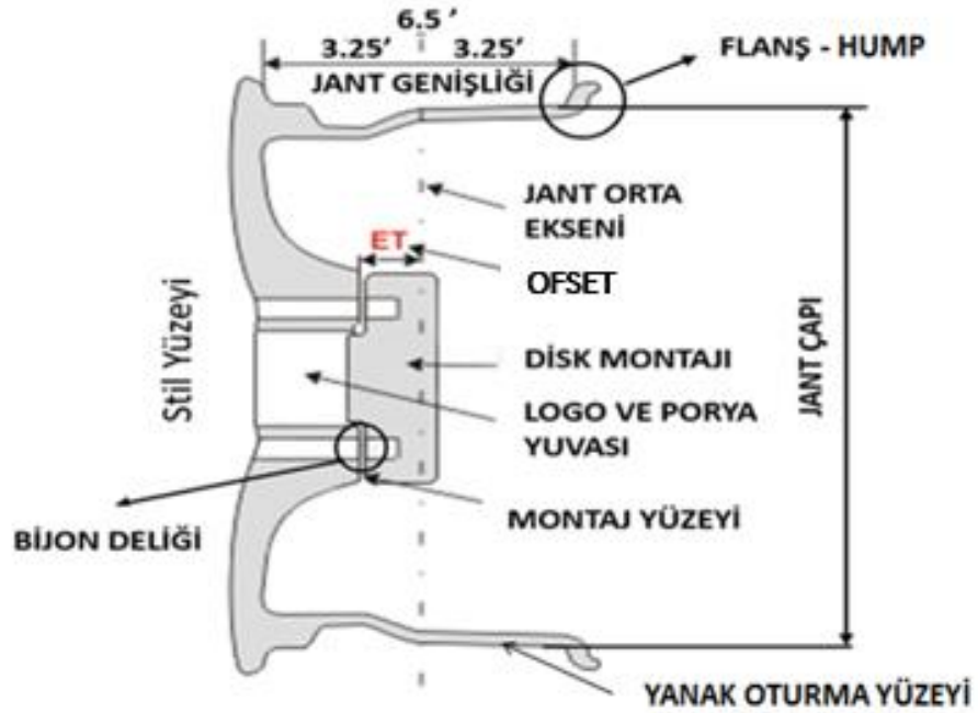
Şekil 3.4 Jant kesiti ve tasarım parametreleri detayı
