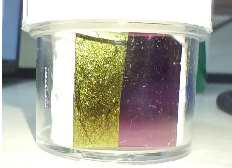
Şekil 3.7. FESEM, EDS ve XRD ölçümleri için silikon alttaş üzerine kaplanan MgF_2 ve CdS numuneleri.
