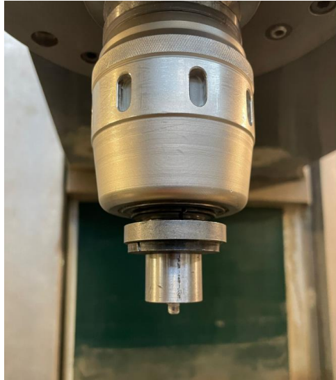
Şekil 3.19 Takımın frezeze bağlanması.
