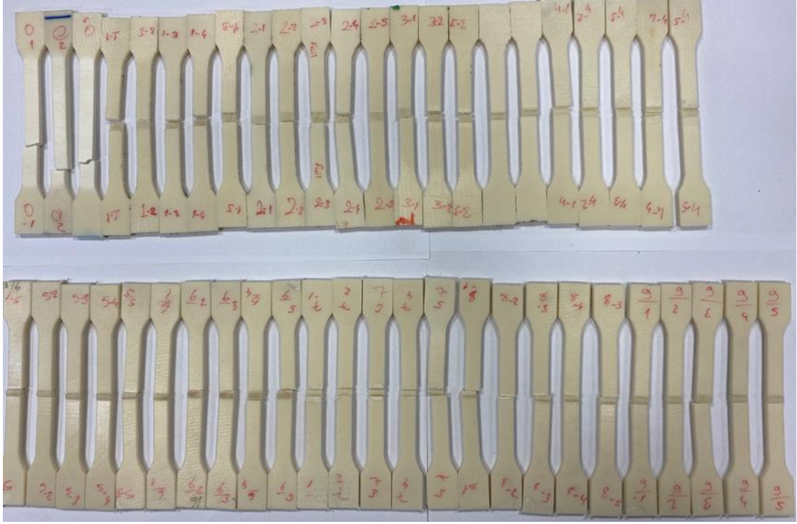
Şekil 4.11 Çekme numunelerinin Zwick roell Z010 ile çekildikten sonra kopulmuş hali ABS M30 malzemesinin sürtünme karıştırma kaynağı ile birleştirilmiş numunelerin çekme deneyi sonucunda akma gerilme değeri sonuçları Çizelge 4.4’te verilmiştir.
