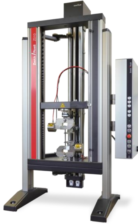
Şekil 3.25 Çekme testi için kullanılan çekme cihazı (Zwick roell Z010).
