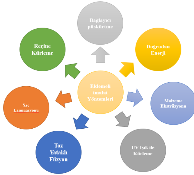
Şekil 2.3 Eklemeli imalat süreçlerinin ISO/ASTM 52900:2015'e göre sınıflandırılması (Lee ve An, 2017).
