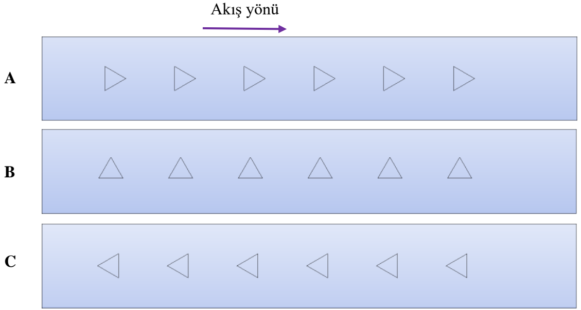
Şekil 3.2. Jet plakalar A) Açısı değiştirilmemiş (A0) B) 90 derece döndürülmüş (A90) C) 180 derece döndürülmüş (A180)
