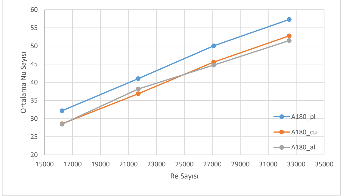
Şekil 4.6. A180 jet plaka tipinde, hedef plaka malzemesindeki değişikliğin ortalama Nu sayısına etkisi
