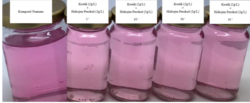
Şekil 4.57. Ozon+kostik+hidrojen peroksit dekolorizasyonu sonrası pembe atık su numunesi
