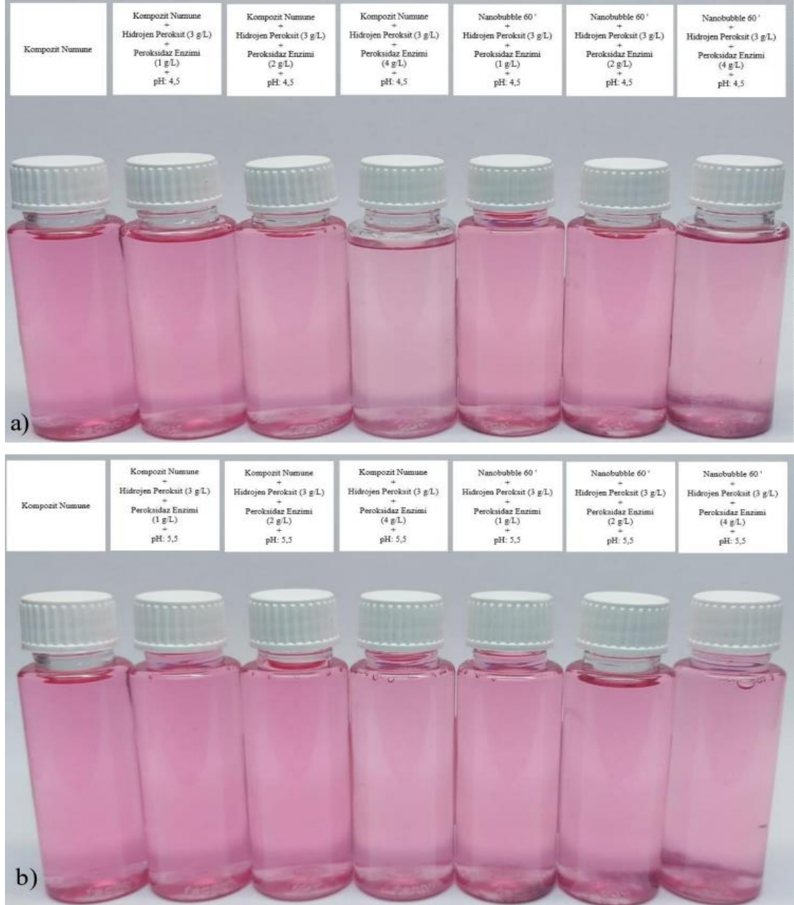
Őekil 4.44. Peroksidaz enzimi+hidrojen peroksit dekolorizasyonu sonrası fuřya atık su numunesi; a) pH 4,5, b) pH 5,5
