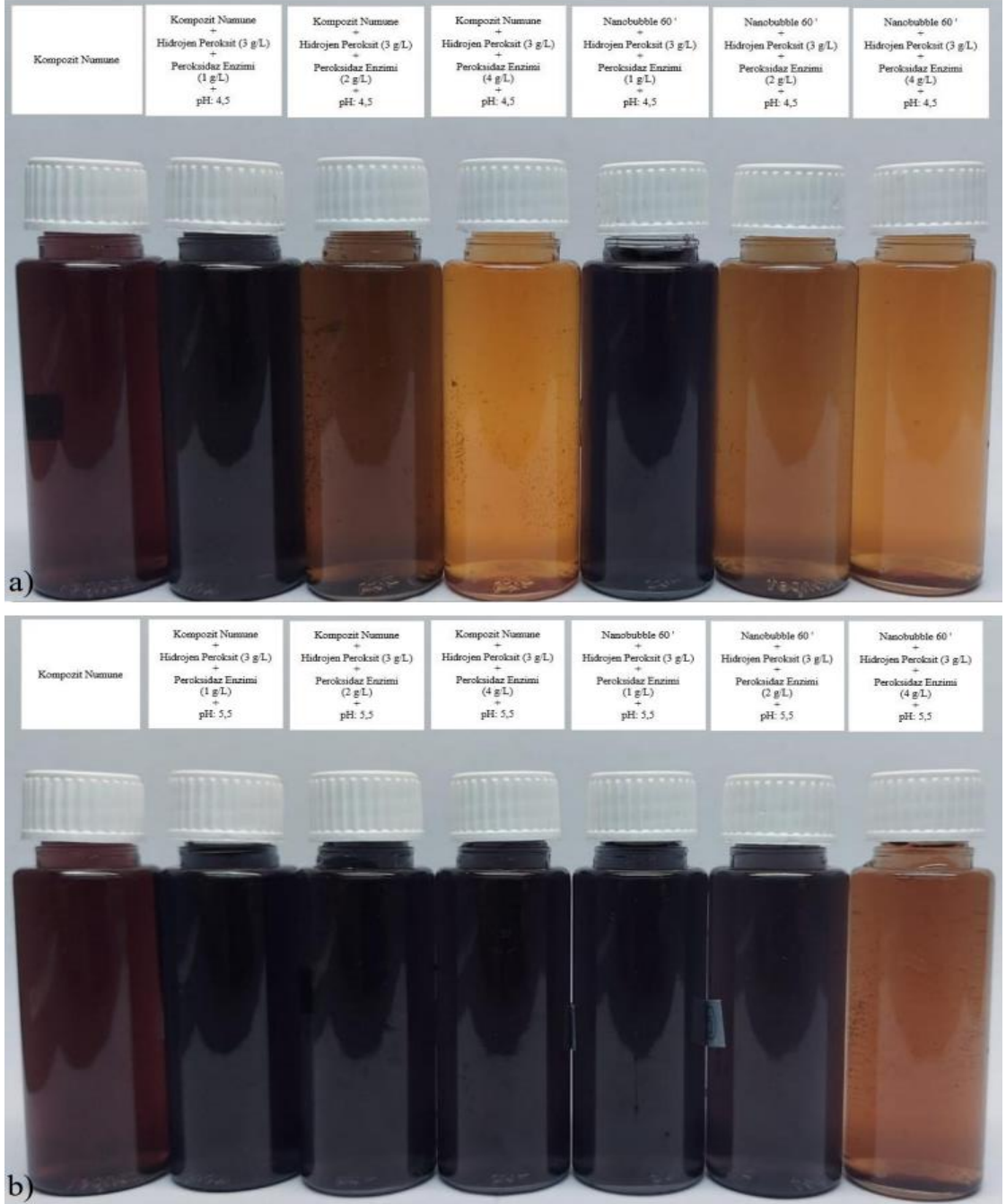
řekil 4.42. Peroksidaz enzimi+hidrojen peroksit dekolorizasyonu sonrası black atık su numunesi; a) pH 4,5, b) pH 5,5
