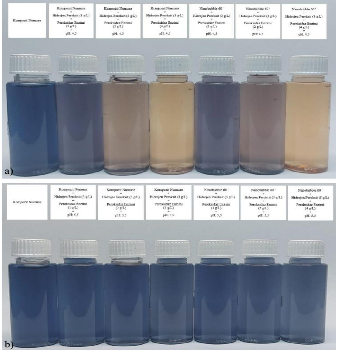
Şekil 4.36. Peroksidaz enzimi+hidrojen peroksit dekolorizasyonu sonrası gj denmark atık su numunesi; a) pH 4,5, b) pH 5,5
