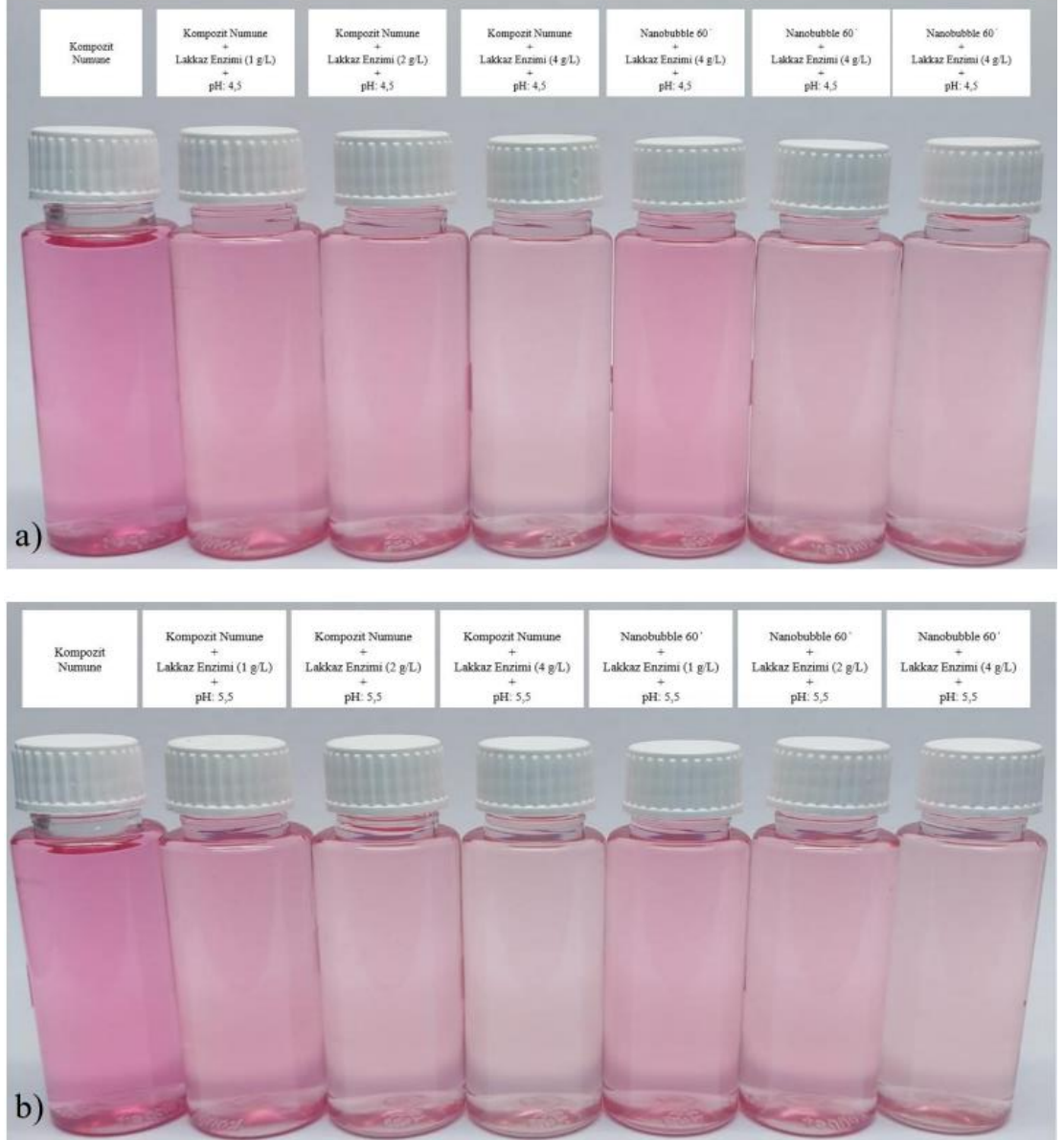
Őekil 4.16. Lakkaz enzim dekolorizasyonu sonrası fuřya atık su numunesi; a) pH 4,5, b) pH 5,5
