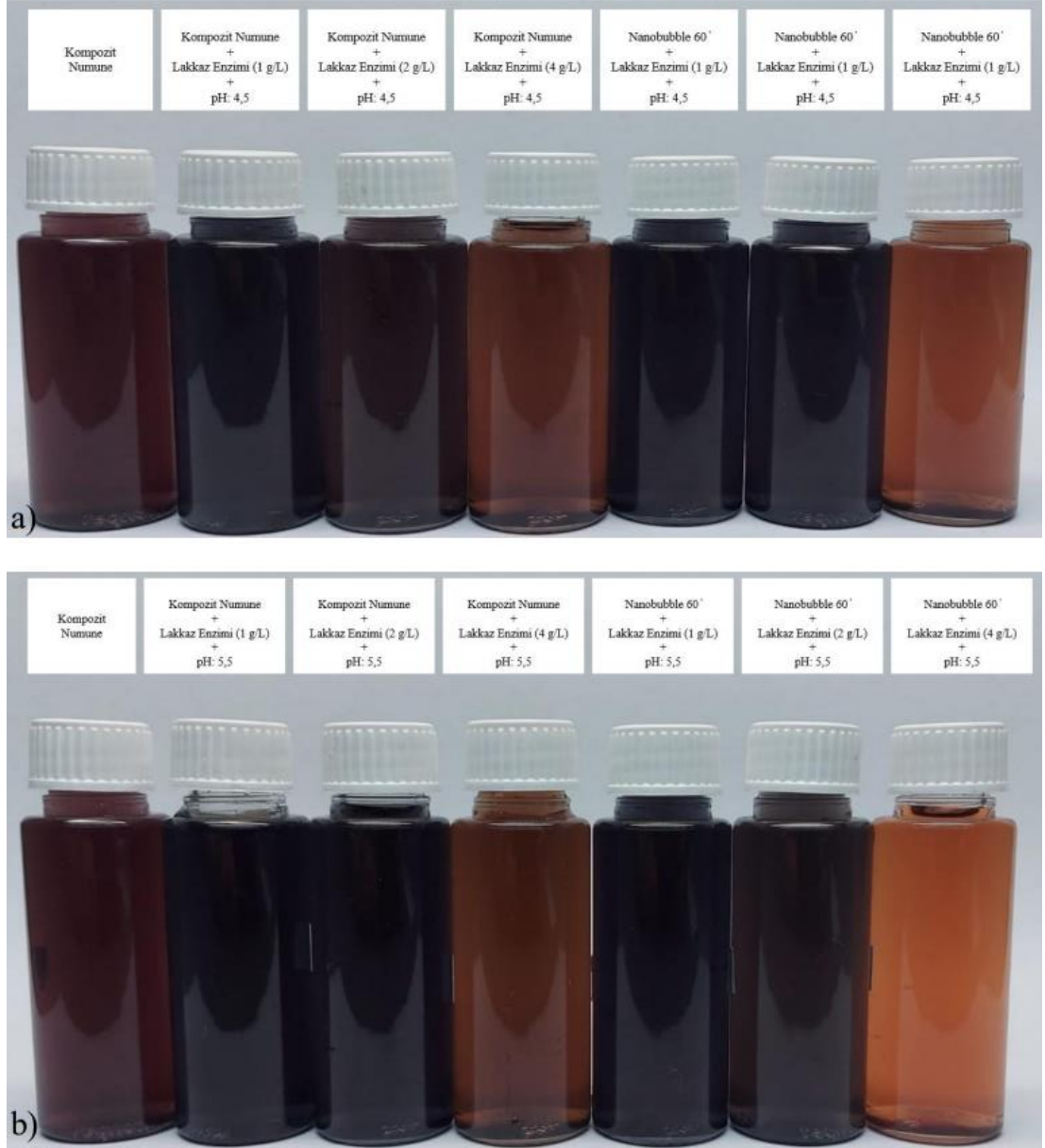
Şekil 4.14. Lakkaz enzim dekolorizasyonu sonrası black atık su numunesi; a) pH 4,5, b) pH 5,5
