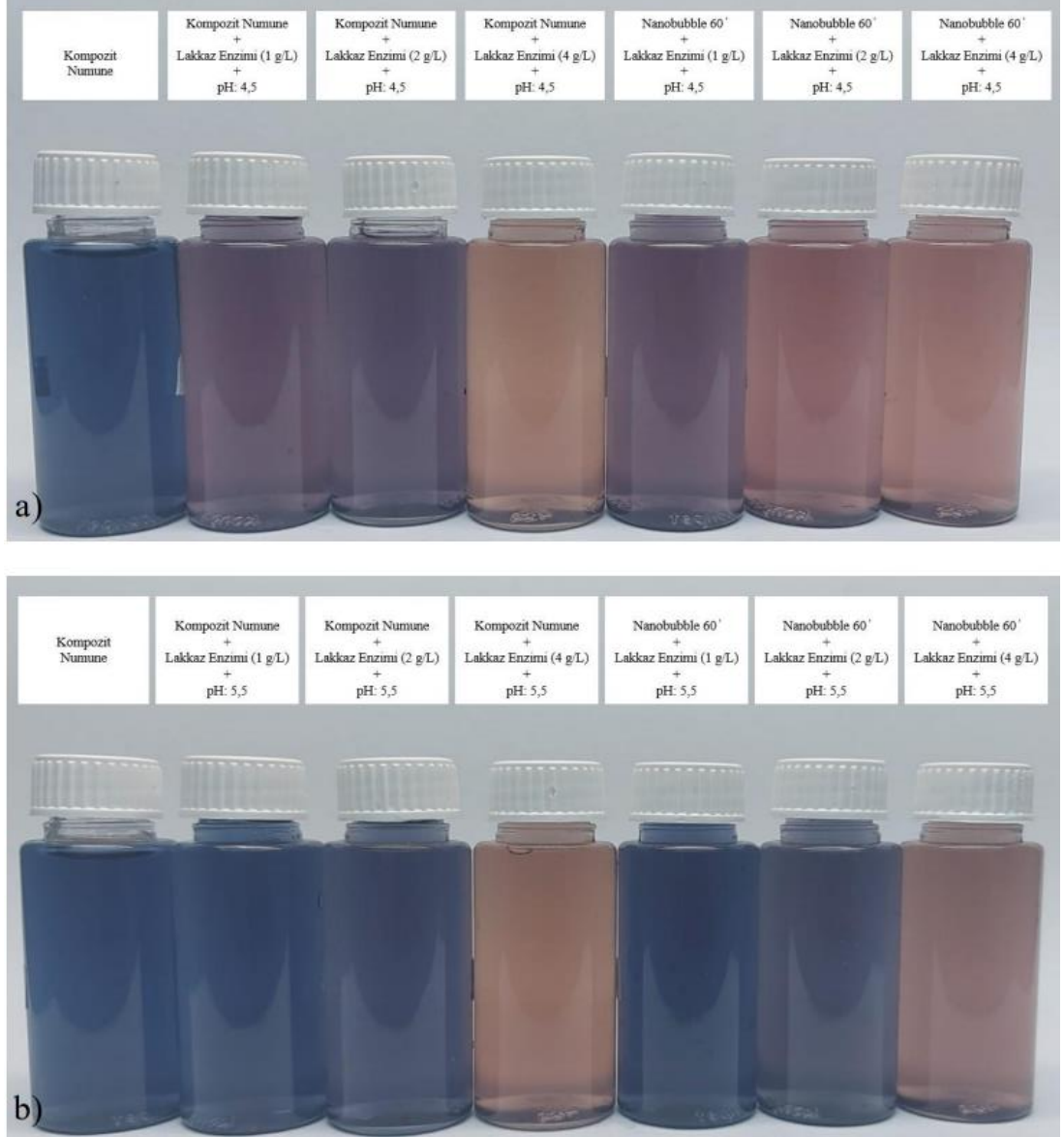
Şekil 4.8. Lakkaz enzimi dekolorizasyonu sonrası gj denmark atık su numunesi; a) pH 4,5, b) pH 5,5
