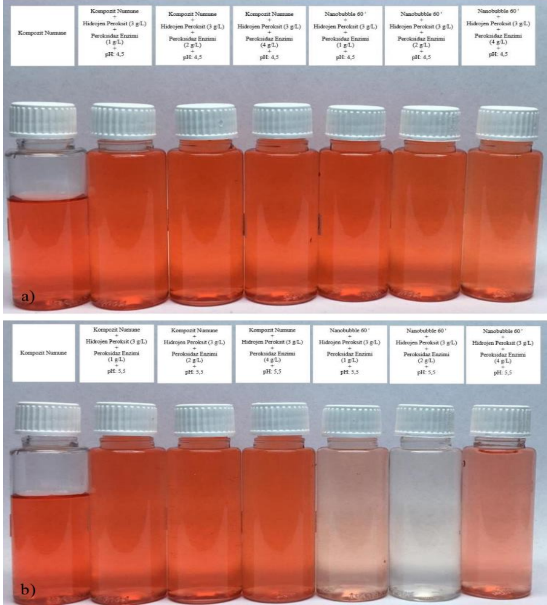
řekil 4.34. Peroksidaz enzimi+hidrojen peroksit dekolorizasyonu sonrası high risk red atık su numunesi; a) pH 4,5, b) pH 5,5
