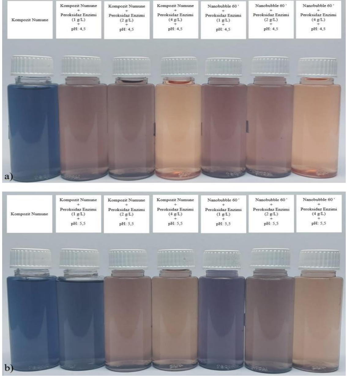
Şekil 4.22. Peroksidaz enzim dekolorizasyonu sonrası gj denmark atık su numunesi; a) pH 4,5, b) pH 5,5
