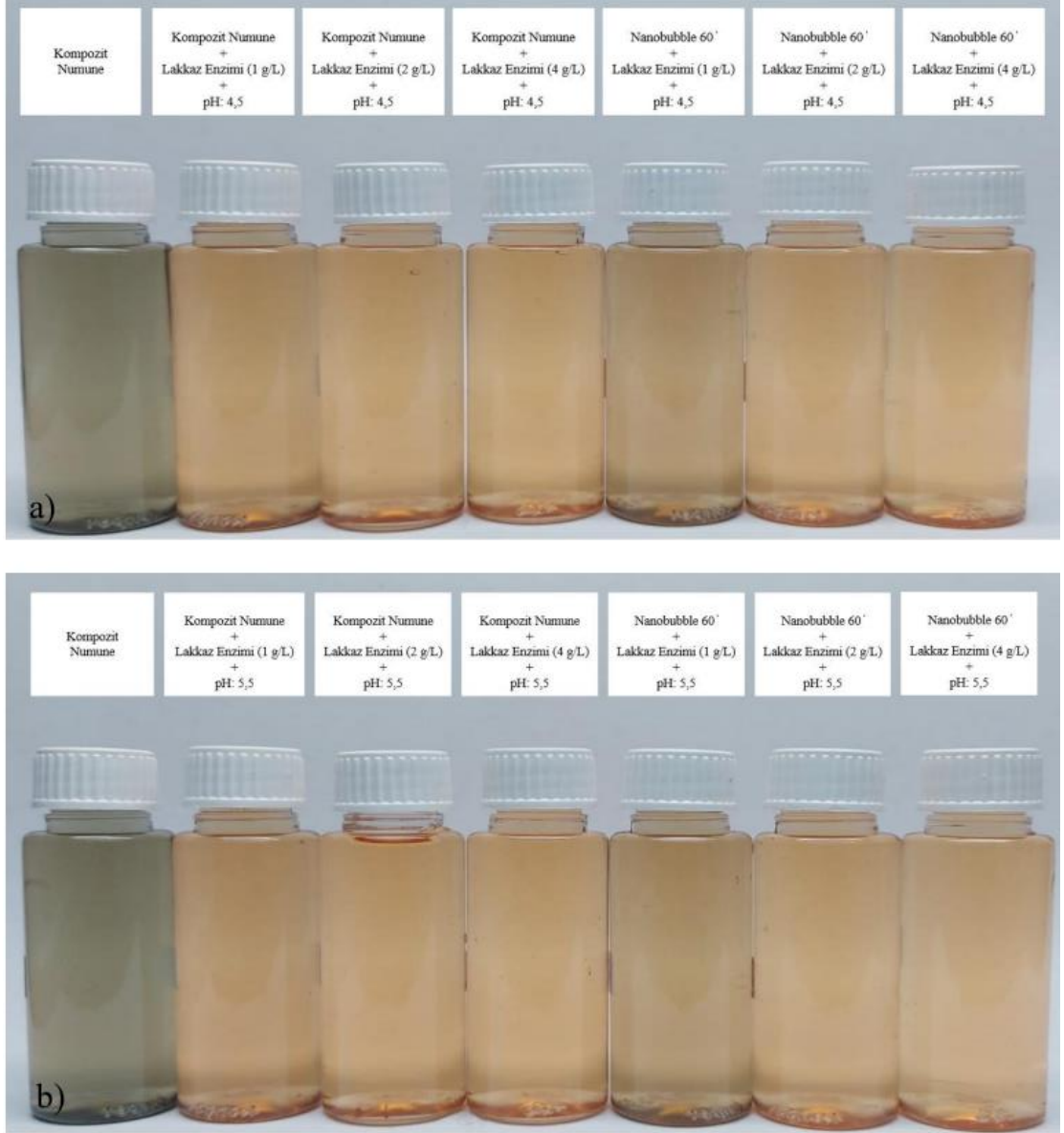
Şekil 4.12. Lakkaz enzim dekolorizasyonu sonrası lacivert atık su numunesi; a) pH 4,5, b) pH 5,5
