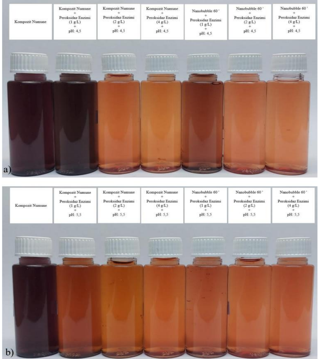
Şekil 4.28. Peroksidaz enzim dekolorizasyonu sonrası black numunesi; a) pH 4,5, b) pH 5,5
