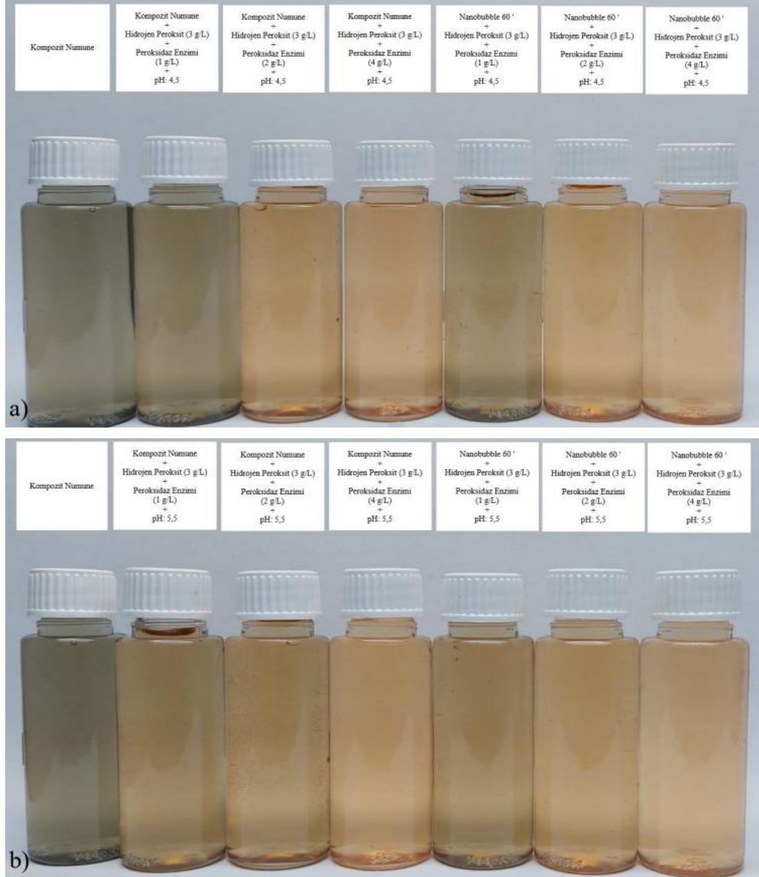
Őekil 4.40. Peroksidaz enzimi+hidrojen peroksit dekolorizasyonu sonrası lacivert atık su numunesi; a) pH 4,5, b) pH 5,5
