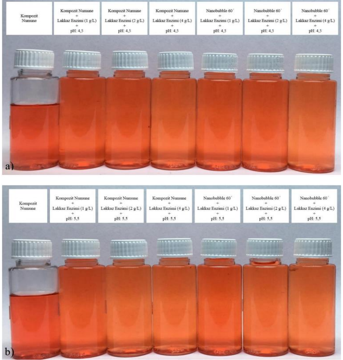
Şekil 4.6. Lakkaz enzimi dekolorizasyonu sonrası high risk red atık su numunesi; a) pH 4,5, b) pH 5,5
