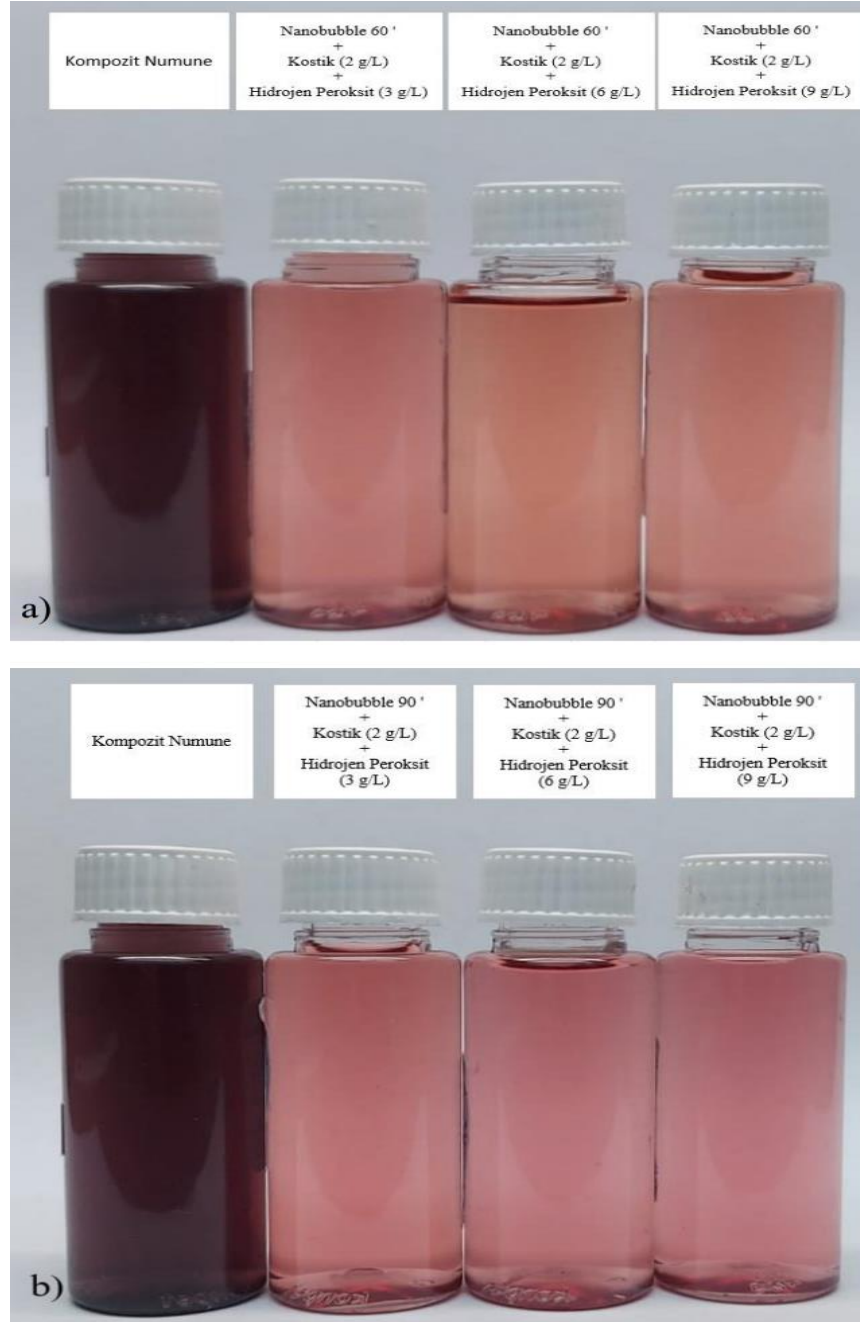
Şekil 4.50. Kostik+hidrojen peroksit dekolizasyonu sonrası black atık su numunesi; a) 60' nanobubble prosesi, b) 90' nanobubble prosesi
