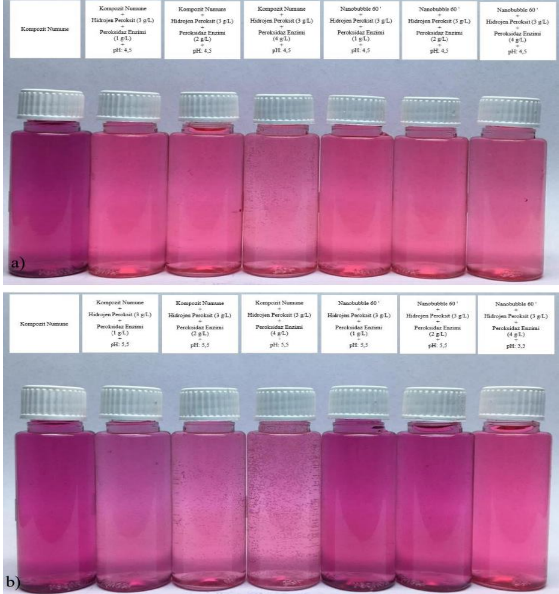
Őekil 4.38. Peroksidaz enzimi+hidrojen peroksit dekolorizasyonu sonrası purple (II) atık su numunesi; a) pH 4,5, b) pH 5,5
