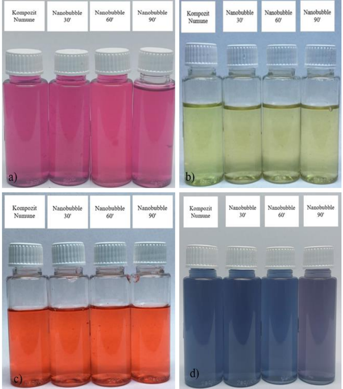
Şekil 4.1. Atık su numunelerine uygulanan nanobubble prosesi; a) purple (I), b) tender shots, c) high risk red, d) gj denmark
