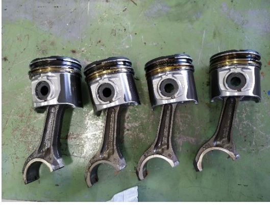
Şekil 4.10. B20 (sol) ve dizel yakıt (sağ) kullanılan pistonlar
