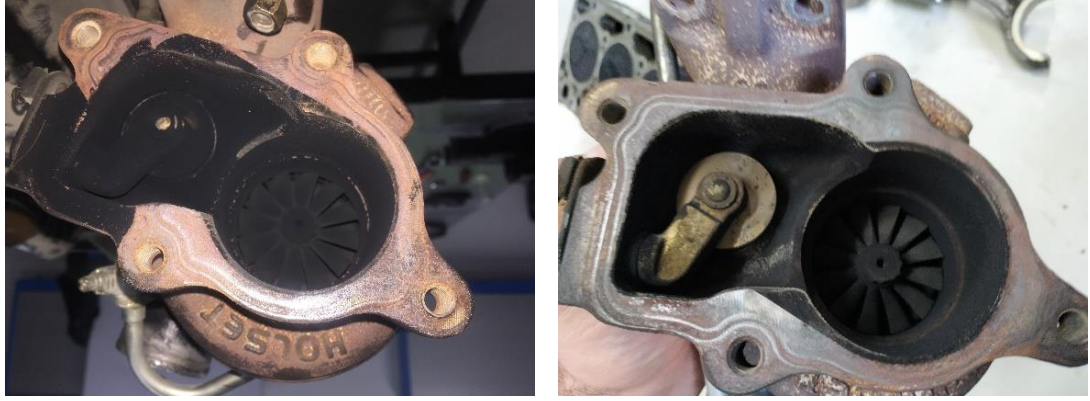
Şekil 4.13. B20 (sol) ve dizel yakıt (sağ) kullanılan turboşarj üniteleri
