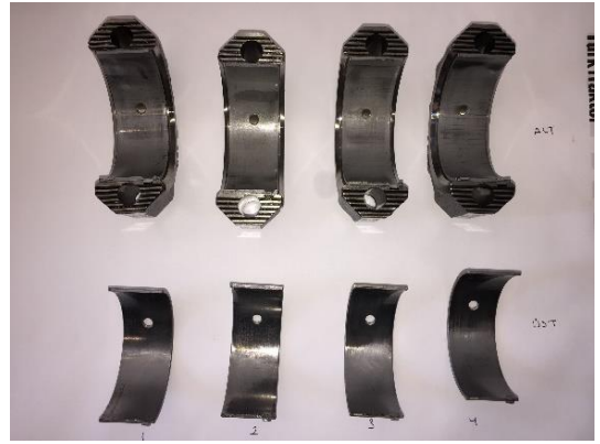
Şekil 4.8. B20 (sol) ve dizel yakıt (sağ) kullanılan kol yatakları
