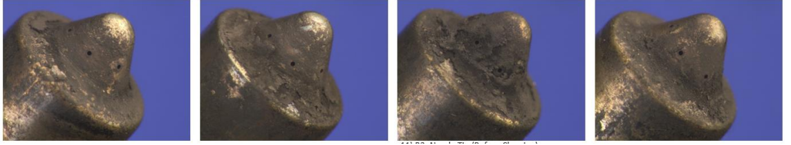
Şekil 4.21. Dizel yakıt ile çalışma sonrası 1, 2, 3 ve 4 numaralı meme uçları (nozzle tips) (temizleme öncesi)
