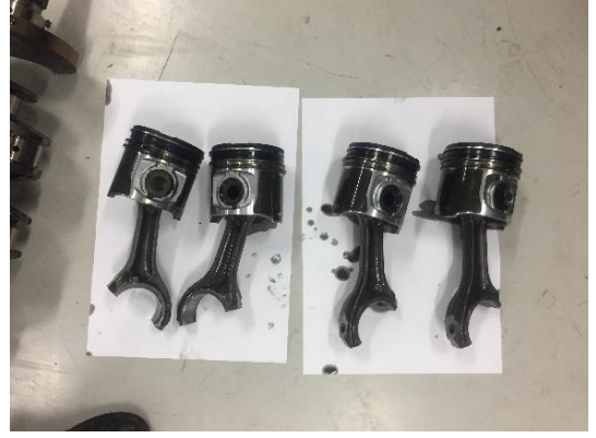
Şekil 4.10. B20 (sol) ve dizel yakıt (sağ) kullanılan pistonlar
