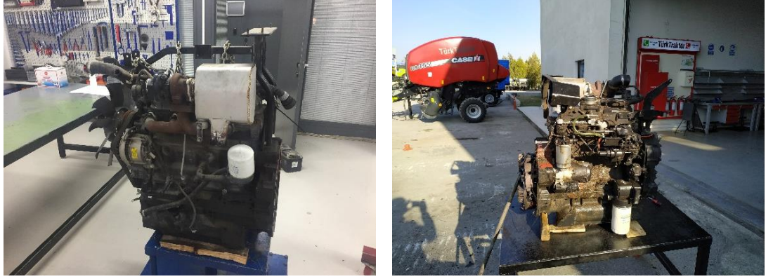
Şekil 4.5. B20 (sol) ve dizel yakıt (sağ) kullanılan traktör motorları
