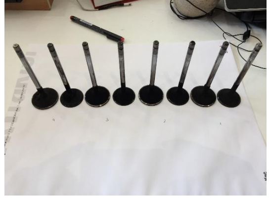
Şekil 4.7. B20 (sol) ve dizel yakıt (sağ) kullanılan motor supapları
