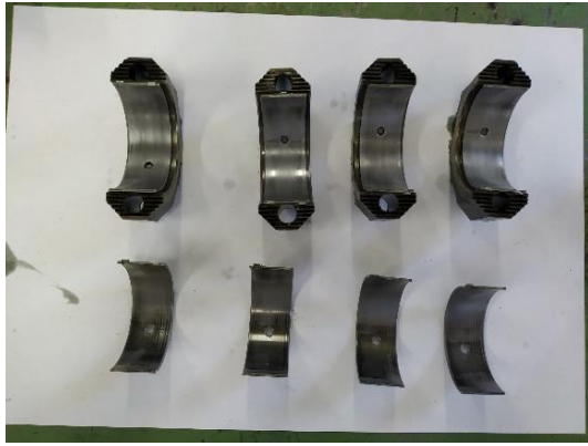
Şekil 4.8. B20 (sol) ve dizel yakıt (sağ) kullanılan kol yatakları
