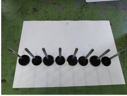
Şekil 4.7. B20 (sol) ve dizel yakıt (sağ) kullanılan motor supapları
