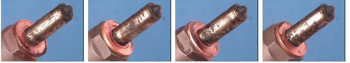
Şekil 4.16. B20 ile çalışma sonrası 1, 2, 3 ve 4 numaralı meme gövdesi (temizleme öncesi)
