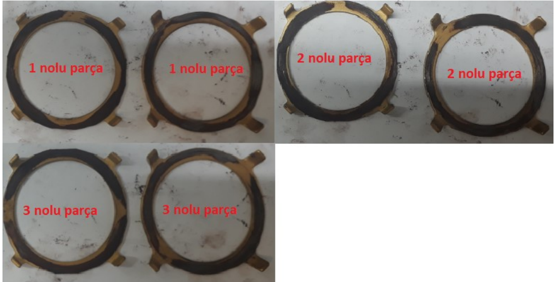
Şekil 4.30: TiN kaplamalı metal tırnaklı rondelâ 50k sonrası kaplama görünümü
