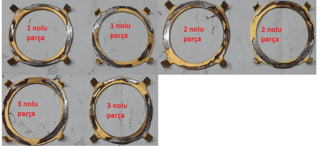
Şekil 4.26: TiN kaplamalı metal tırnaklı rondelâ 20k sonrası kaplama görünümü
