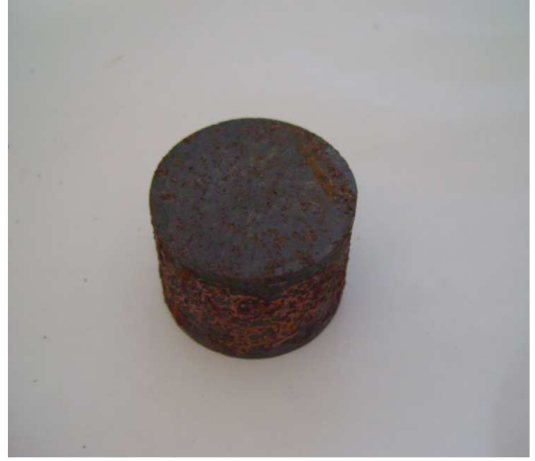
Şekil 4.10 AISI 420 plazma nitrileme 520 °C de 165 saat sonundaki görüntüsü
