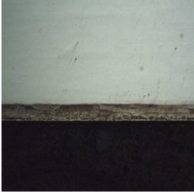
Şekil 4.41 AISI 430 Tuz Nitrüleme Nitrüleme 570 °C (100X)
