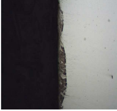
Şekil 4.36 AISI 430 Gaz Nitrüleme 570 °C (200X)
