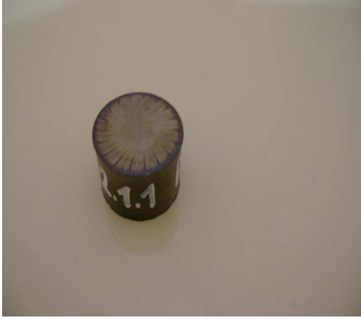
Şekil 4.7 AISI 304 520 °C de plazma nitrülenmiş numune
