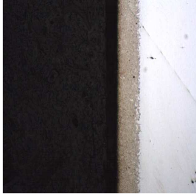
Şekil 4.32 AISI 420 Plazma Nitürleme 520 °C (100X)
