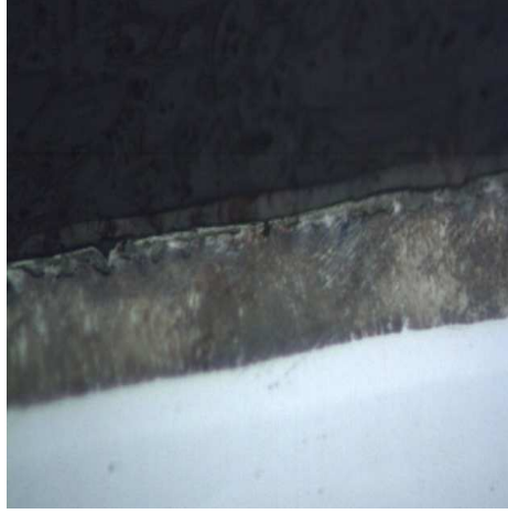
Şekil 4.31 AISI 304 Plazma Nitrürleme 520 °C (400X)
