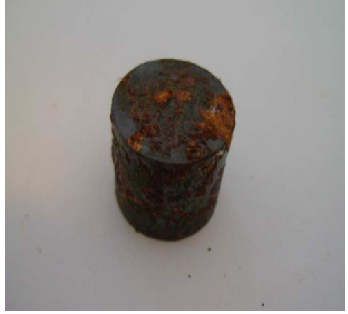
Şekil 4.8 AISI 304 plazma nitrileme 520 °C de 68 saat sonundaki görüntüsü
