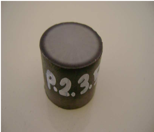
Şekil 4.11 AISI 430 520 °C de plazma nitrülenmiş numune
