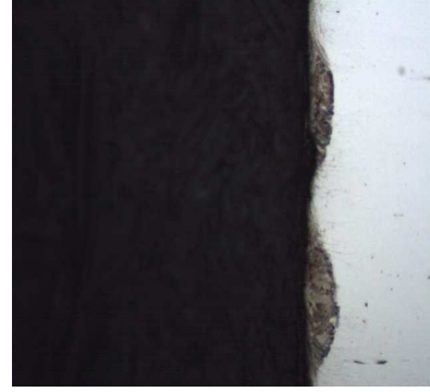
Şekil 4.37 AISI 430 Gaz Nitrüleme 570 °C (200X)
