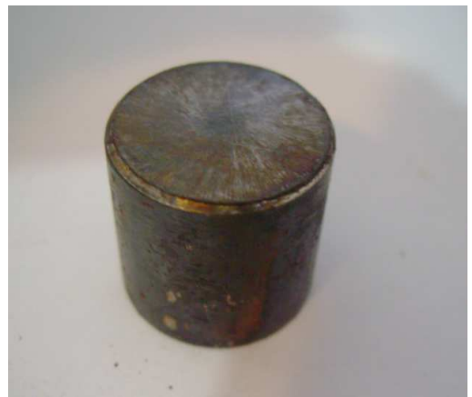
Şekil 4.6 AISI 430 plazma nitrürleme 450 °C de 165 saat sonundaki görüntüsü
