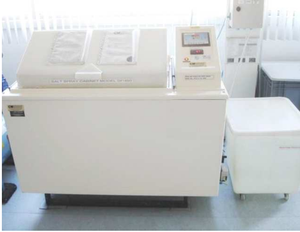
Şekil 3.5 Tuzlu sis test kabini
