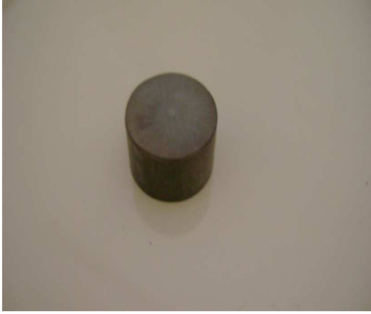
Şekil 4.21 AISI 420 570 °C de gaz nitrülenmiş numune
