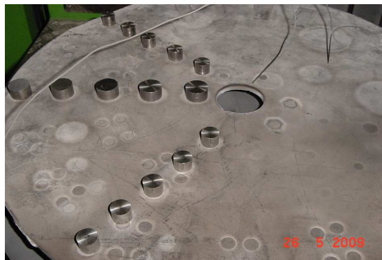
Şekil 3.4 Plazma nitrürleme fırını içerisindeki parçaların görüntüsü
