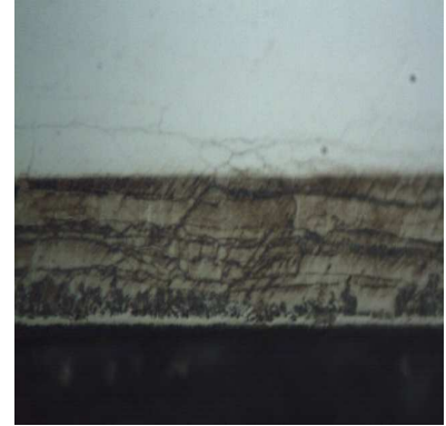
Şekil 4.42 AISI 430 Tuz 570 °C (400X)
