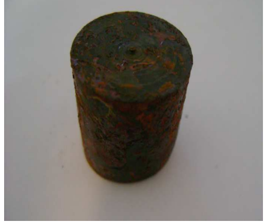
Şekil 4.14 AISI 304 tuz nitrileme 570 °C de 327 saat sonundaki görüntüsü
