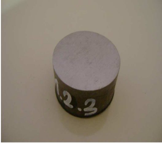
Şekil 4.3 AISI 420 450 °C de plazma nitrülenmiş numune
