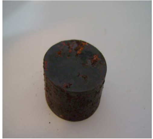
Şekil 4.4 AISI 420 plazma nitrürleme 450 °C de 165 saat sonundaki görüntüsü
