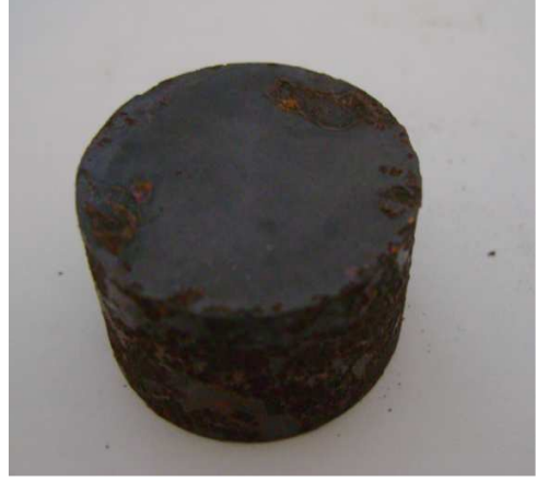
Şekil 4.16 AISI 420 tuz 570 °C de nitrileme 327 saat sonundaki görüntüsü
