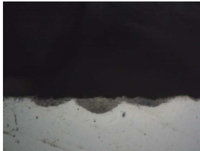
Şekil 4.34 AISI 304 Gaz Nitürleme 570 °C (400X)
