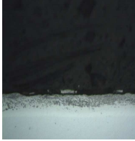
Şekil 4.28 AISI 304 Plazma Nitürleme 450 °C (400X)
