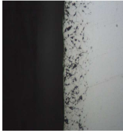
Şekil 4.29 AISI 420 Plazma Nitürleme 450 °C (400X)
