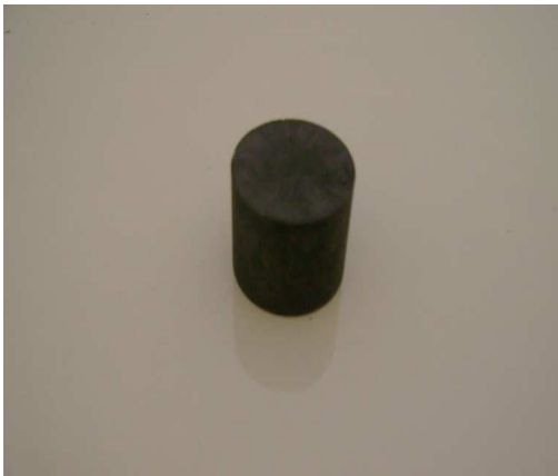
Şekil 4.17 AISI 430 570 °C de tuz nitrülenmiş numune
