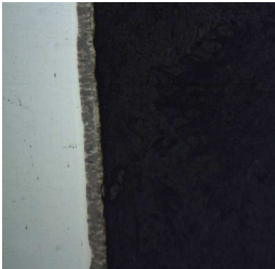
Şekil 4.38 AISI 304 Tuz Nitrüleme 570 °C (100X)
