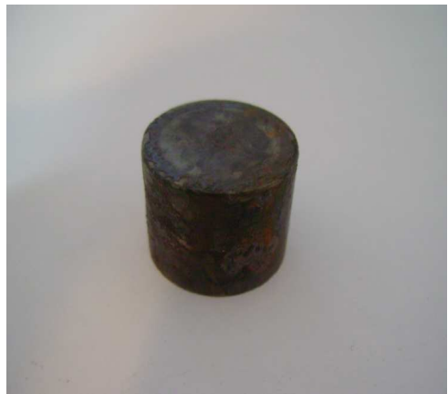
Şekil 4.12 AISI 430 plazma nitrileme 520 °C de 237 saat sonundaki görüntüsü
