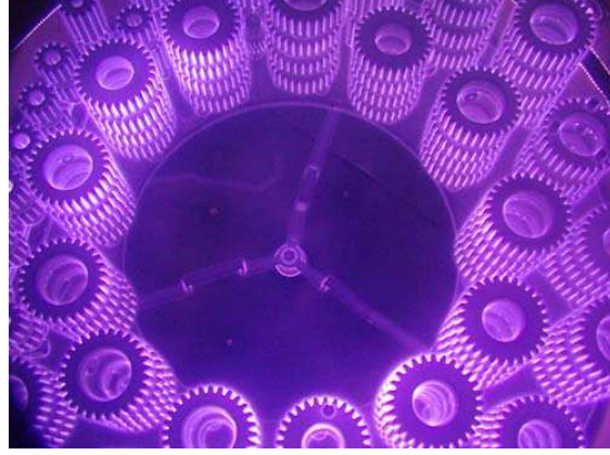
Şekil 2.6 SAE 1050 çeliğinden imal edilmiş dişlilerin plazma nitrürleme fırınında işlem sırasındaki görüntüsü ( http://www.istanbulisil.com 2009)
