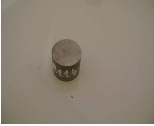
Şekil 4.1 AISI 304 450 °C de plazma nitrülenmiş numune
