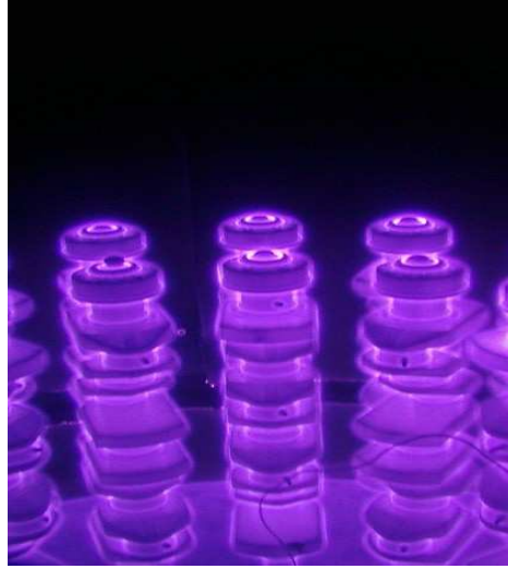
Şekil 2.7 Dizel araçlarda kullanılan krank millerinin plazma nitrürleme işlemi sırasındaki görüntüsü ( http://www.istanbulisil.com 2009)
