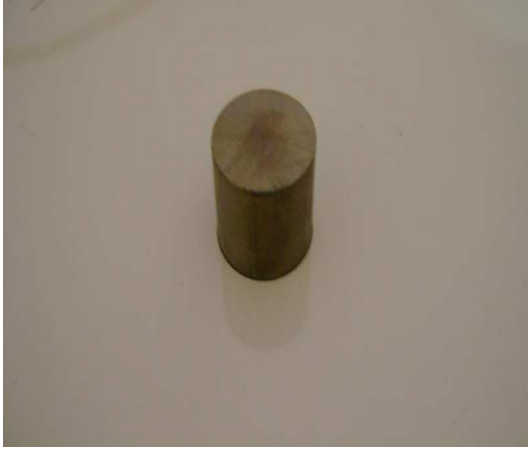
Şekil 4.19 AISI 304 570 °C de gaz nitrülenmiş numune
