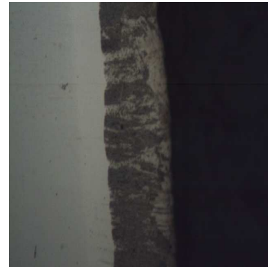
Şekil 4.39 AISI 304 Tuz Nitrüleme 570 °C (400X)
