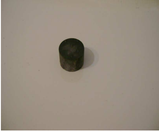
Şekil 4.15 AISI 420 570 °C de tuz nitrülenmiş numune
