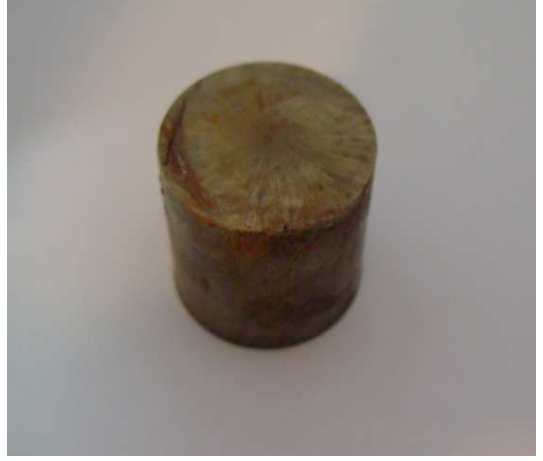
Şekil 4.20 AISI 304 570 °C de gaz nitrüleme 237 saat sonundaki görüntüsü
