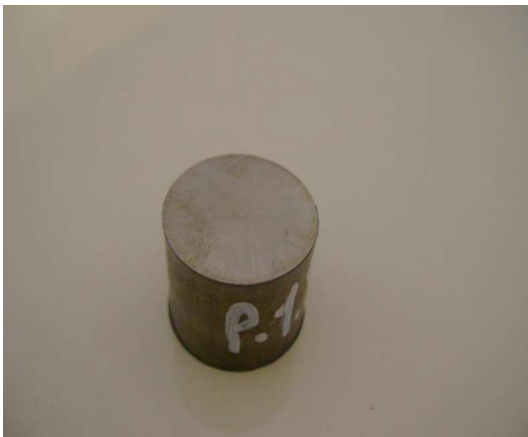
Şekil 4.5 AISI 430 450 °C de plazma nitrülenmiş numune
