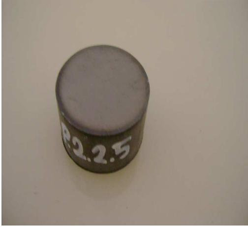
Şekil 4.9 AISI 420 520 °C de plazma nitrülenmiş numune
