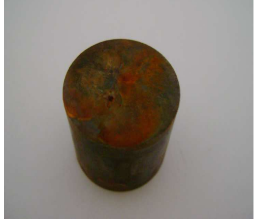
Şekil 4.2 AISI 304 450 °C de plazma nitrürleme 690 saat sonundaki görüntüsü
