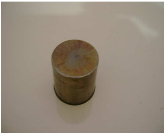
Şekil 4.23 AISI 430 570 °C de gaz nitrülenmiş numune
