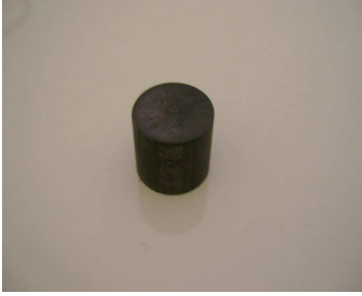
Şekil 4.13 AISI 304 570 °C de tuz nitrülenmiş numune
