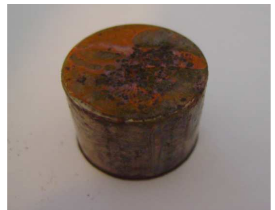
Şekil 4.24 AISI 430 570 °C de gaz nitrüleme 68 saat sonundaki görüntüsü
