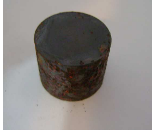
Şekil 4.18 AISI 430 570 °C de tuz nitrileme 327 saat sonundaki görüntüsü
