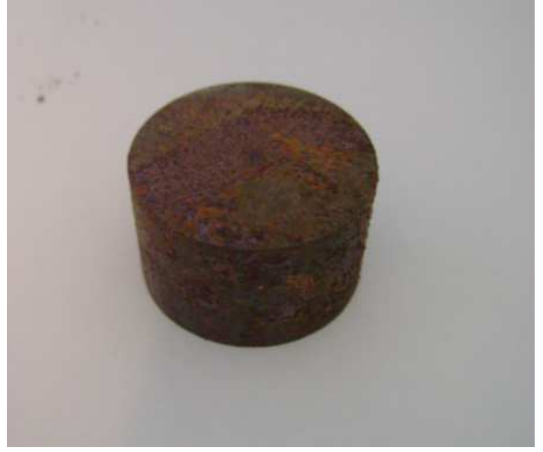
Şekil 4.22 AISI 420 570 °C de gaz nitrüleme 68 saat sonundaki görüntüsü
